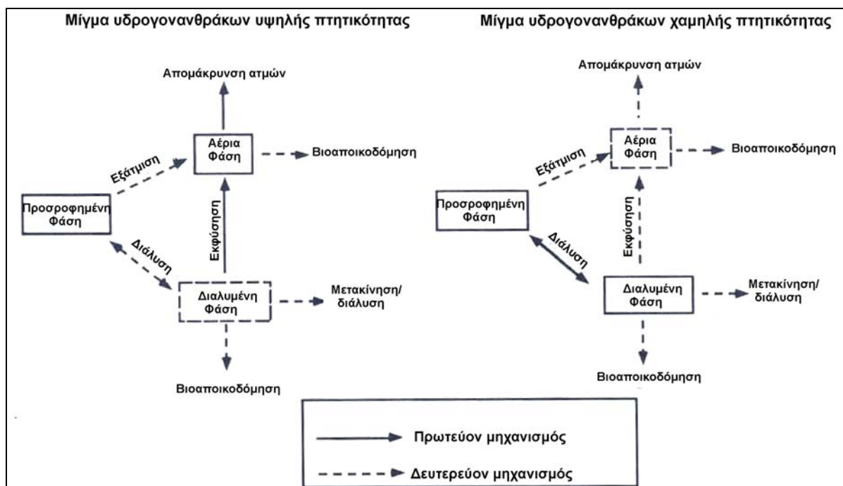
Σχήμα 11: Μηχανισμοί κατανομής και απομάκρυνσης ρυπαντών, συναρτήσει της εξάτμισης, κατά τη διάρκεια εφαρμογής της τεχνολογίας air sparging (Norris et al., 1994).
