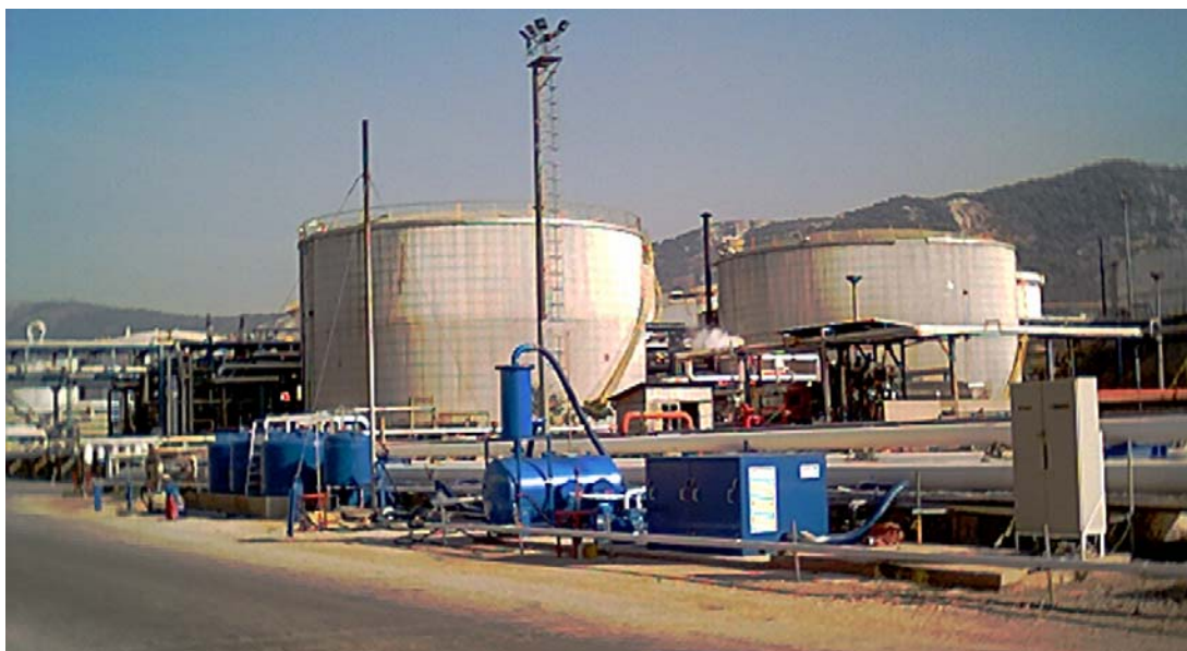
Εικόνα 1: Όψη του υπάρχοντος συστήματος άντλησης ελαιωδών (bioslurping) στις εγκαταστάσεις του διυλιστηρίου Ασπροπύργου.
