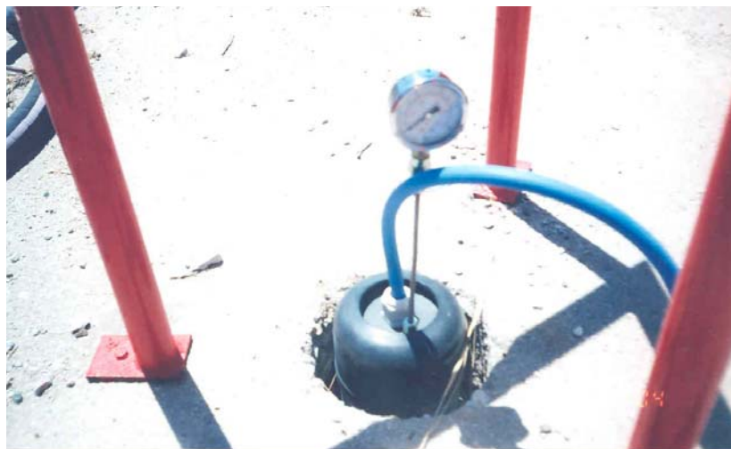
Εικόνα 5: Τυπικό πηγάδι του συστήματος, όπου φαίνεται το βιδωτό καπάκι, η πλάκα PVC, ο σωλήνας παροχής αέρα και το μανόμετρο που χρησιμοποιείται για την παρακολούθηση της αναπτυσσόμενης πίεσης.
