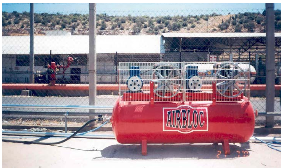
Εικόνα 2: Ο αεροσυμπιεστής δυο κεφαλών, αντικρηκτικού τύπου. Στα αριστερά φαίνεται η μαύρη σωλήνα που οδηγεί τον αέρα στο κολεκτέρ, όπου γίνεται και η κατανομή του στα πηγάδια.
