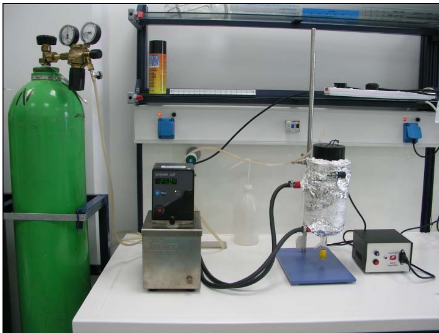
Φωτογραφία 1. Πειραματική διάταξη φωτοκατάλυσης όπου φαίνεται η φιάλη αέρα, η μονάδα ελέγχου θερμοκρασίας συνδεδεμένη στο λουτρό ύδατος που περιέχει το διάλυμα ΟΠ και η γεννήτρια της λάμπας UV
