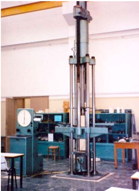
Σχήμα 4.3: Υδραυλικό πλαίσιο φόρτωσης AMSLER του εργαστηρίου αντοχής υλικών του Ε.Μ.Π
