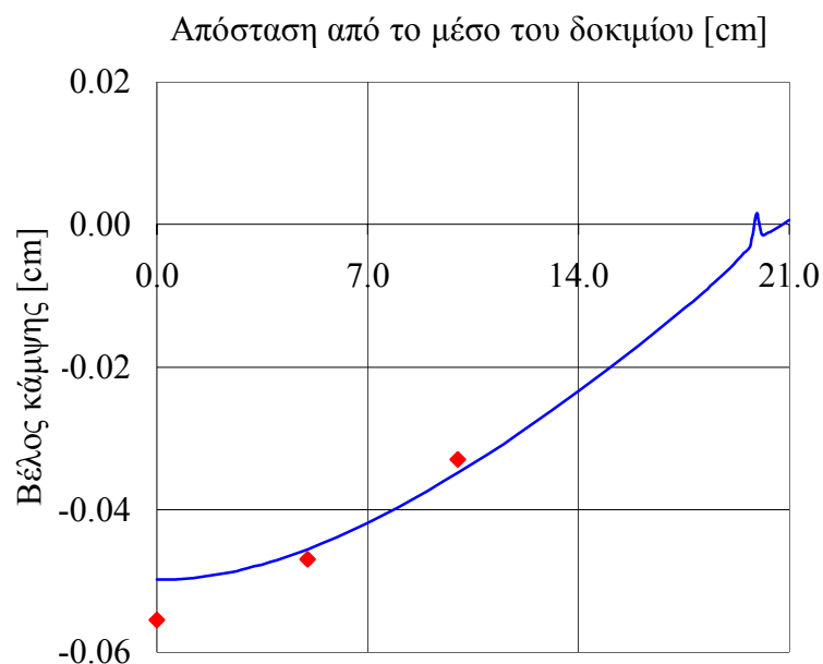
Σχήμα 6.5: Γραφική παράσταση του βέλους κάμψης της κάτω ακμής του δοκιμίου λίγο πριν την θραύση
