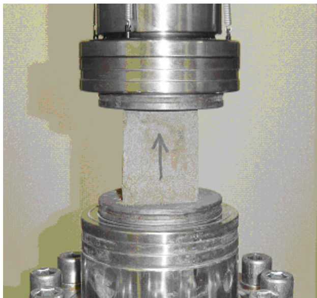
Σχήμα 4.3: Δοκίμιο φόρτισης για τη δοκιμή μονοαξονικής θλίψης.
