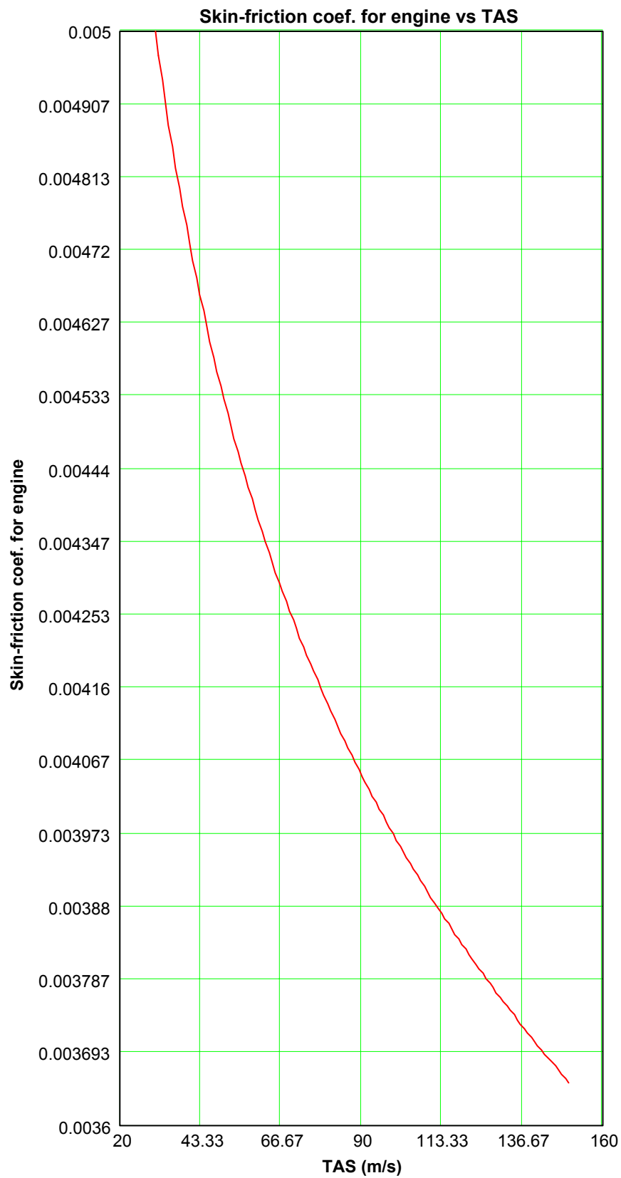
Διάγραμμα 2.7. Υπολογιζόμενος συντελεστής παρασιτικής αντίστασης της ατράκτου συναρτήσει πραγματικής ταχύτητας αέρα.
