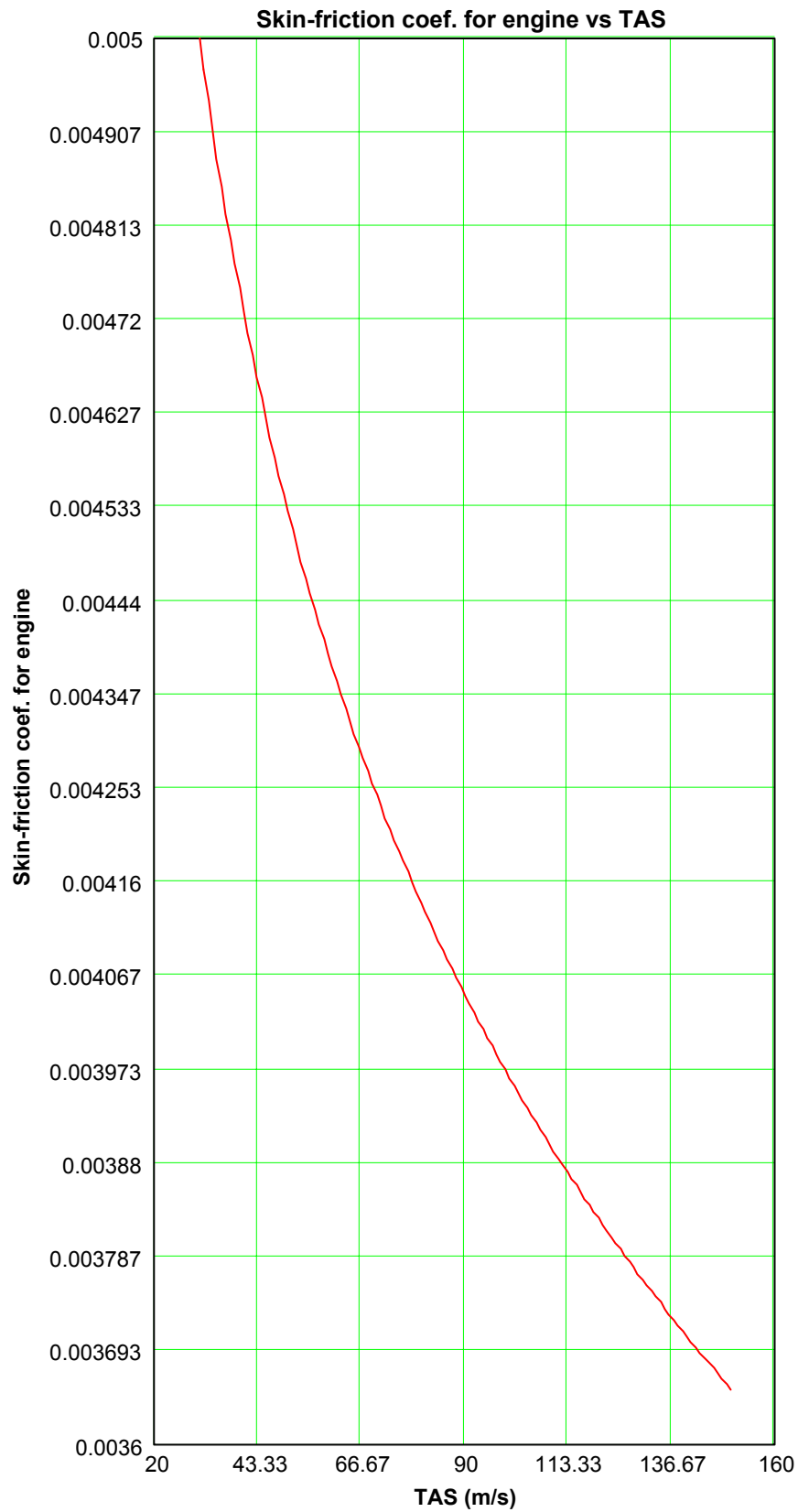
Διάγραμμα 2.8. Υπολογιζόμενος συντελεστής επιφανειακής τριβής του κινητήρα συναρτήσει πραγματικής ταχύτητας αέρα.
