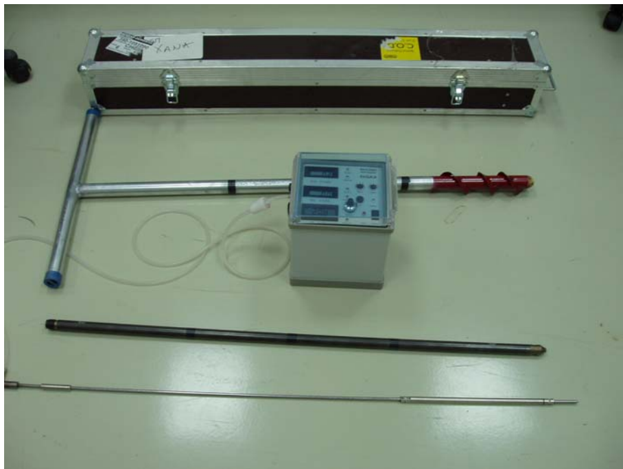
Εικόνα 10-4: Η διάταξη μέτρησης των εδαφικών αερίων
