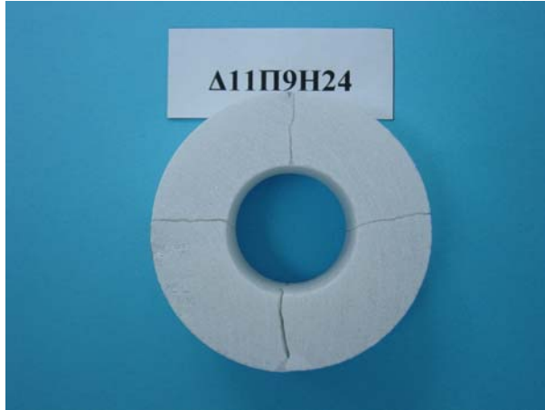
Δοκίμιο d = 24 \text{ mm} ( q = 0.444 ). Περίπτωση (d).
