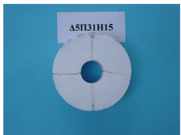
Δοκίμιο d = 15 \text{ mm} ( q = 0.278 ). Περίπτωση (δ).
