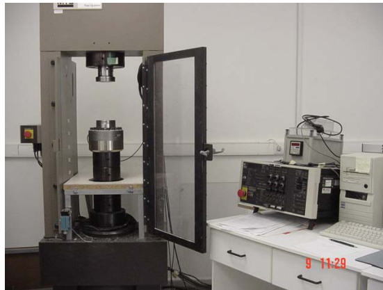
Σχήμα 7.7: Συσκευή φόρτισης MTS-815
