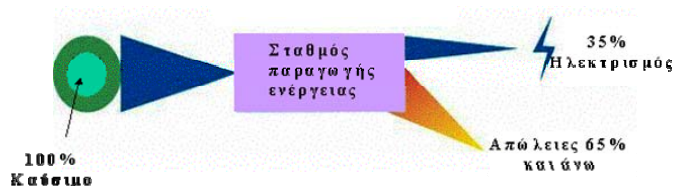
Σχήμα 19: Τυπικό συμβατικό σύστημα παραγωγής ηλεκτρικής ενέργειας [44]
