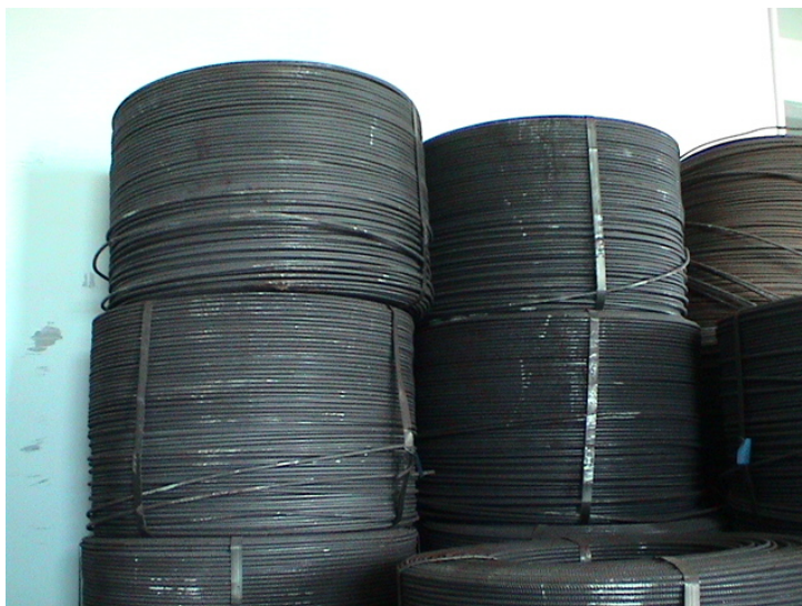
Εικόνα 5.10: Αποθηκευμένοι ρόλοι (κουλούρες) S500s διατομής Φ10 σε επιχείρηση διαμόρφωσης «θωράκων»
