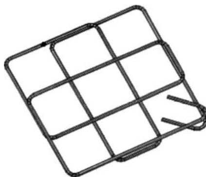
Εικόνα 5.13: Σύνθετος μονοκόμματος συνδετήρας μιας στρώσης
