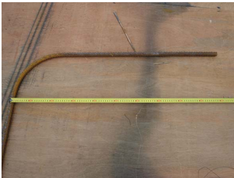
Εικόνα 6.28: Έλεγχος μήκους αγκύρωσης ράβδου δοκού Φ16 (μήκος γάντζου 1μ.)
