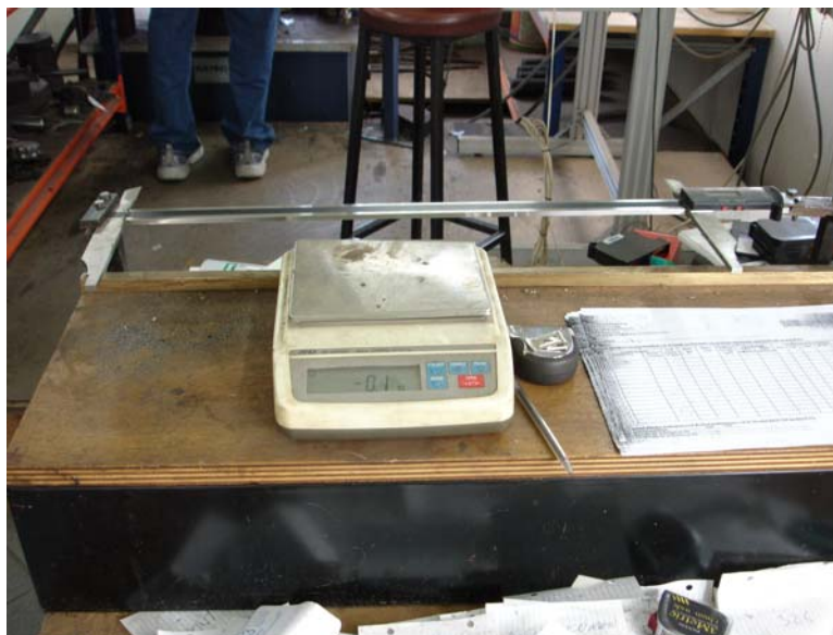
Εικόνα 6.14: Ηλεκτρονική ζυγαριά και μετρητής μήκους δοκιμίου
