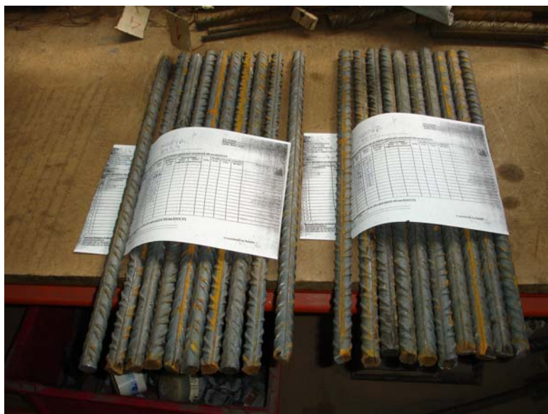
Εικόνα 6.15: Δοκίμια χαλύβων πριν τη δοκιμή εφελκυσμού
