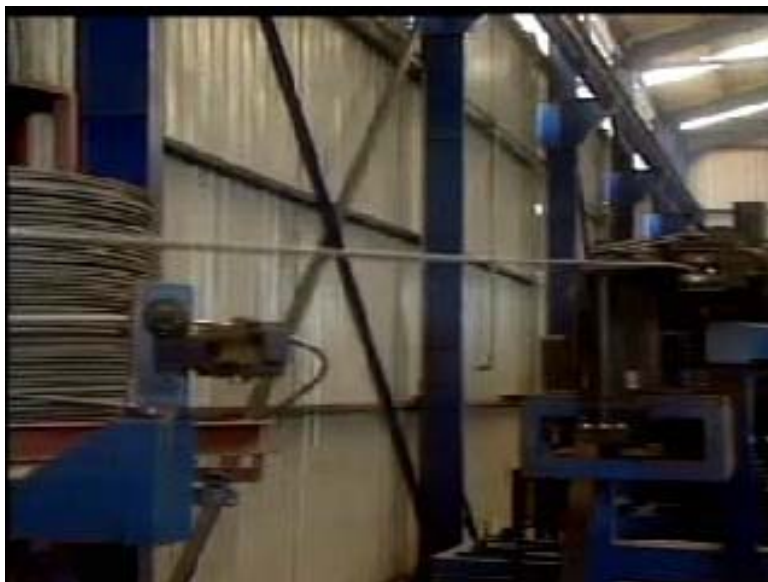
Εικόνα 5.2: Αυτόματη μηχανή ευθυγράμμισης, κάμψης και κοπής
