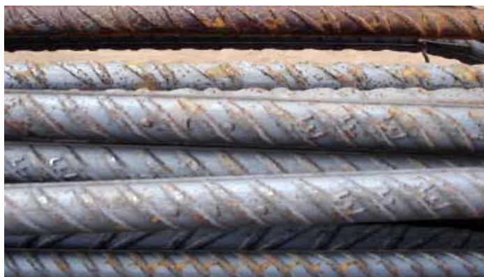
Εικόνα 1.17: Ανάγλυφα σημάδια και γράμματα, για την αναγνώριση χώρας / εργοστασίου (Efesan Demir A.S. - E.F.E.)
