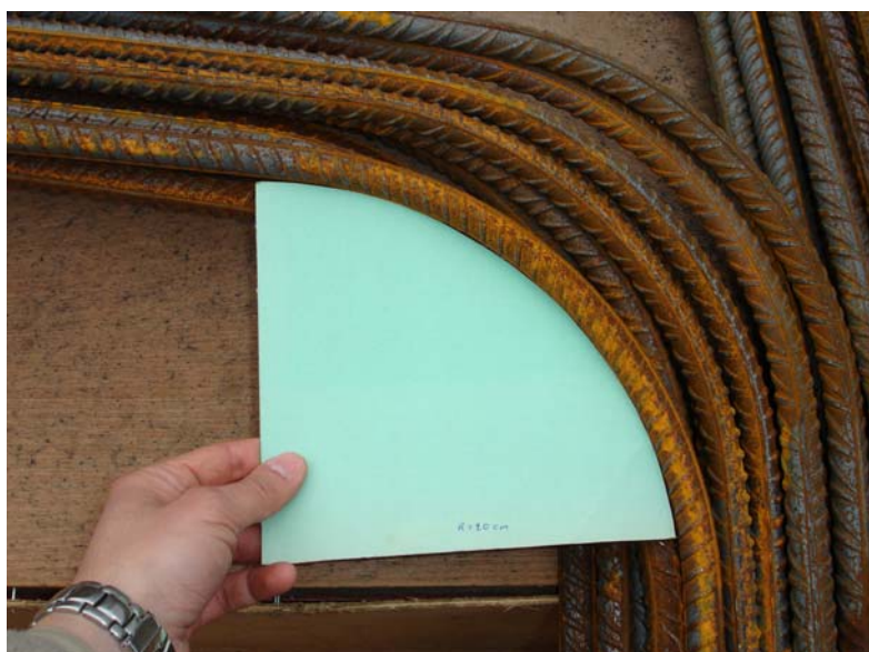
Εικόνα 6.24: Έλεγχος διαμέτρου καμπύλωσης ράβδου (διάμετρος καμπύλωσης 20Φ)
