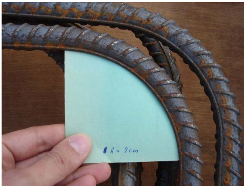
Εικόνα 6.23: Έλεγχος διαμέτρου καμπύλωσης ράβδου (διάμετρος καμπύλωσης 9Φ)
