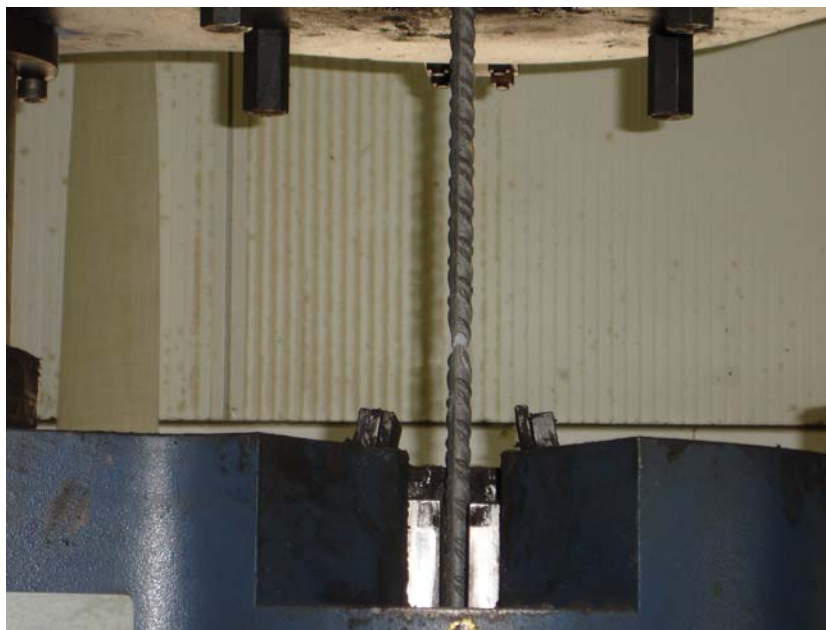
Εικόνα 6.18: Δοκίμιο που μόλις έχει θραυστεί στην μηχανή εφελκυσμού
