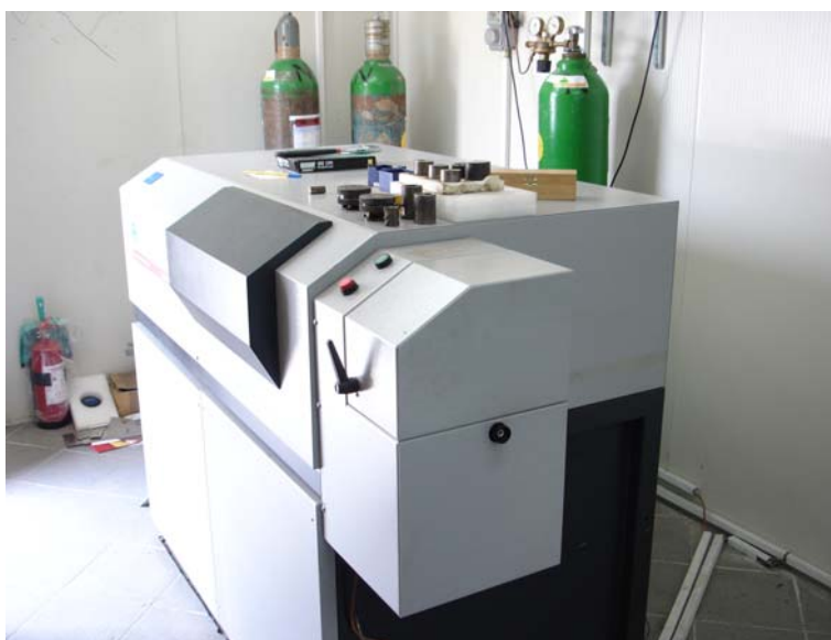
Εικόνα 6.19: Φασματογράφος ατομικής εκπομπής του Κ.Ε.Δ.Ε
