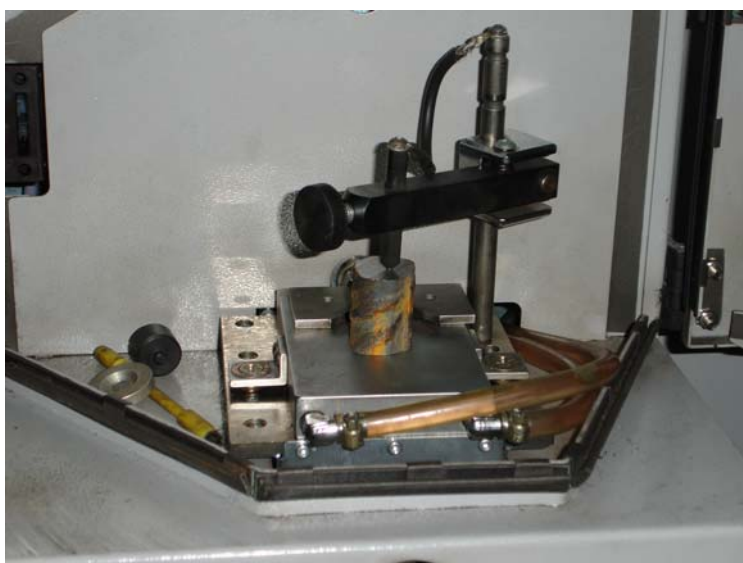
Εικόνα 6.20: Δοκίμιο που υποβάλλεται σε διέγερση σπινθήρα στον φασματογράφο
