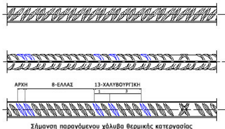
Εικόνα 1.15: Χάλυβας οπλισμού κατηγορίας ποιότητας S500s από τη Χαλυβουργική. Διακρίνεται και το X ως πρόσθετο εταιρικό σήμα
