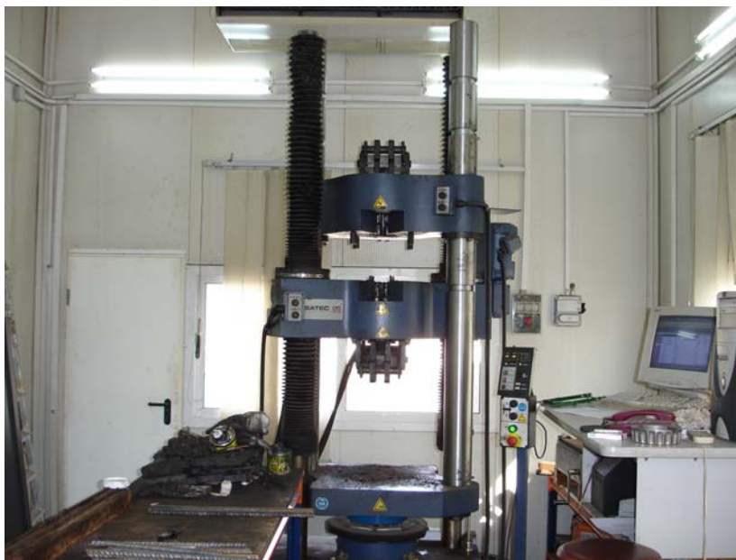
Εικόνα 6.16: Μηχανή εφελκυσμού του Κ.Ε.Δ.Ε.
