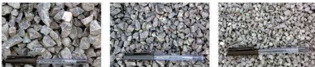
Εικόνα 3.17 . Ταξινόμηση αδρανών υλικών ανάλογα με το μέγεθος τους
