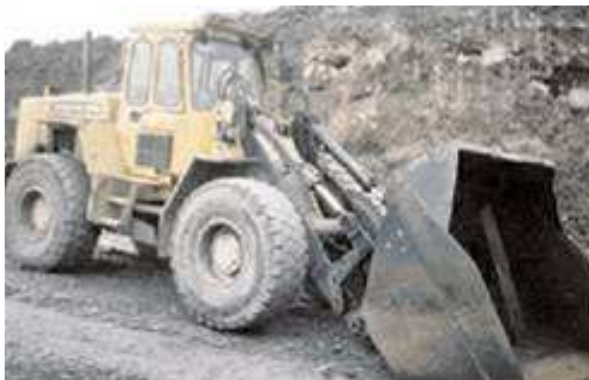
Εικόνα 3.28. Περίπτωση υπερμεγέθους κάδου σε φορτωτή [26]
