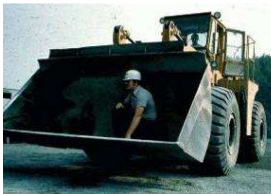
Εικόνα 3.30. Κακή πρακτική. Σε περίπτωση πτώσης του εργαζομένου από τον κάδο, ο χειριστής δεν έχει ορατότητα για να σταματήσει.
