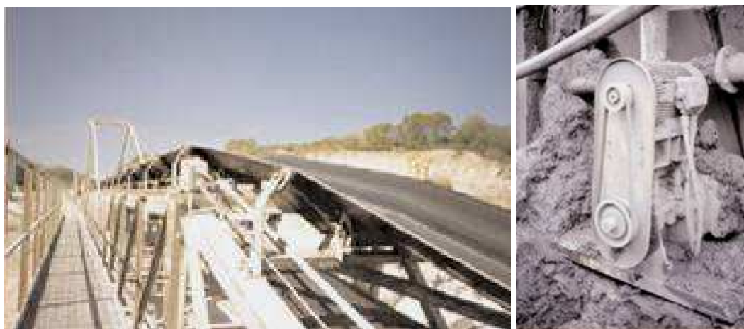
Εικόνα 3.37. Κίνδυνος τραυματισμού από κινούμενη ταινία μεταφοράς υλικού και ακάλυπτους ιμάντες κίνησης [27]
