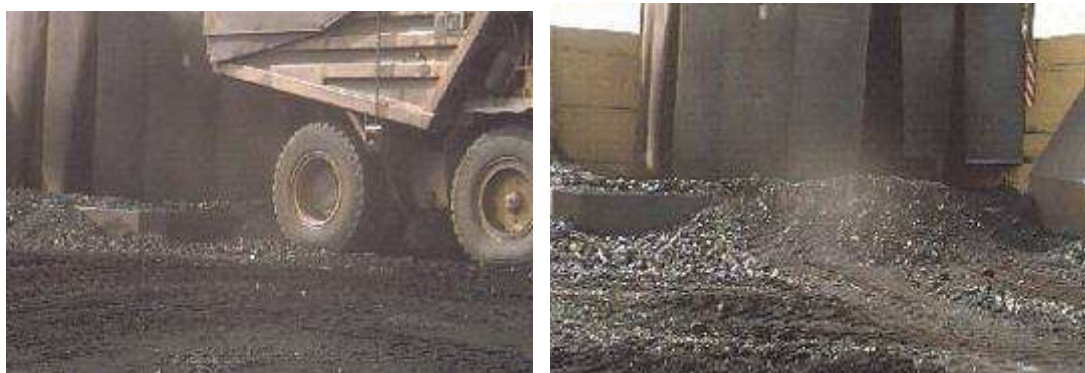
Εικόνα 4.12 Τα προστατευτικά μπορεί να καλυφθούν με αδρανή και να πάψουν να είναι αποτελεσματικά.
