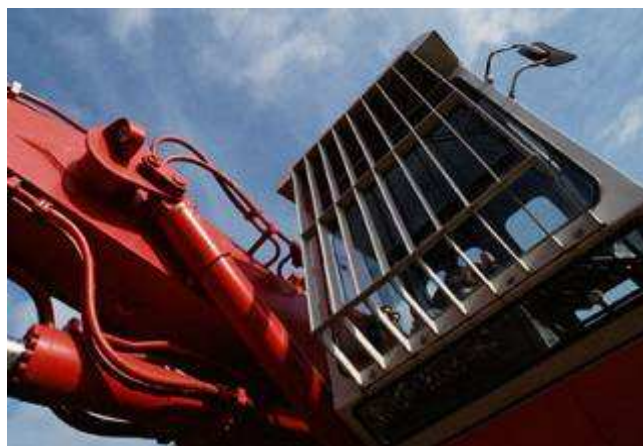
Εικόνα 4.26 Προστασία του χειριστή εκσκαφέα από εκτίναξη υλικών.
