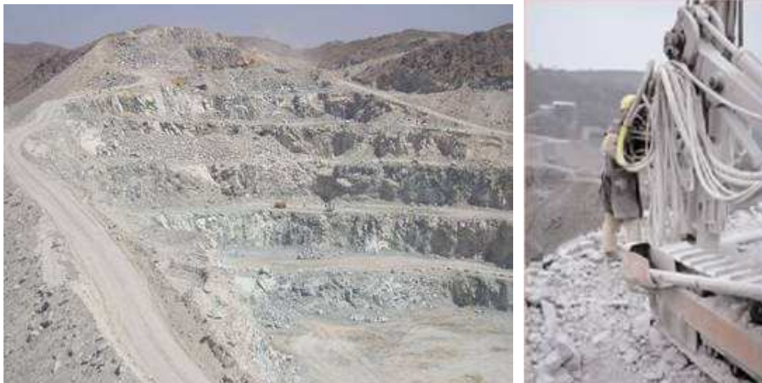
Εικόνα 3.39. Ο χειριστής του διατρητικού οχήματος εργάζεται στην άκρη του μετώπου χωρίς κανένα μέσο προστασίας.
