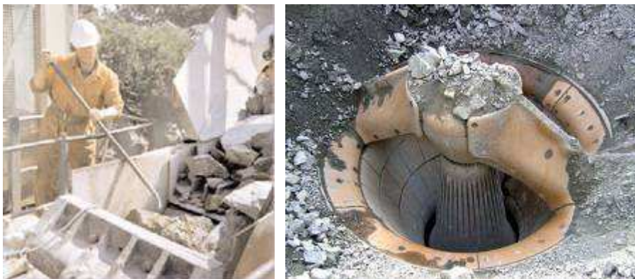
Εικόνα 3.36. Κίνδυνος τραυματισμού κατά την απεμπλοκή ενός μπλοκαρισμένου θραυστήρα [27]
