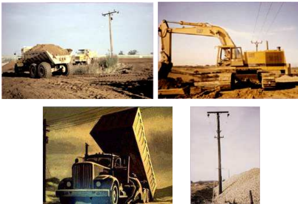
Εικόνα 3.45. Κίνδυνος ηλεκτροπληξίας κατά την επαφή οχήματος με εναέρια ηλεκτροφόρα καλώδια [27]
