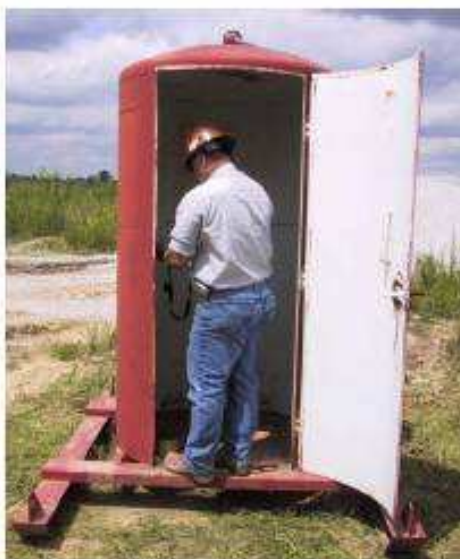
Εικόνα 4.39 Προστατευτικό στέγαστρο ανατινάξεων [12]
