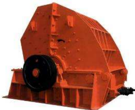
Εικόνα 3.12. Θραυστήρας με περιστρεφόμενα μαχαίρια
