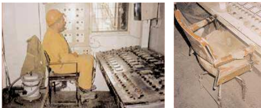
Εικόνα 3.52. Συσσωρευμένη σκόνη σε δωμάτιο ελέγχου [27]
