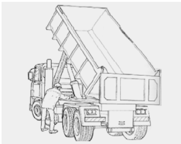
Εικόνα 4.4 Εργασίες συντήρησης χωρίς μέτρα ασφάλειας
