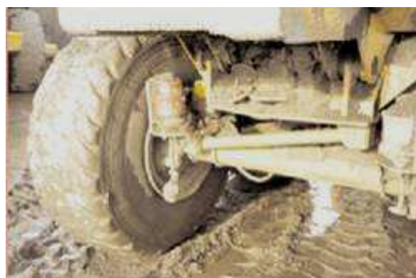
Εικόνα 3.32. Κίνδυνος ατυχήματος από κατεστραμμένη ανάρτηση [27]
