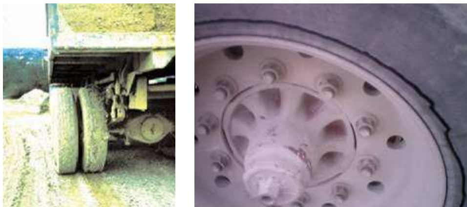
Εικόνα 3.33. Τα φθαρμένα ελαστικά μπορεί να προκαλέσουν σοβαρό ατύχημα [27]
