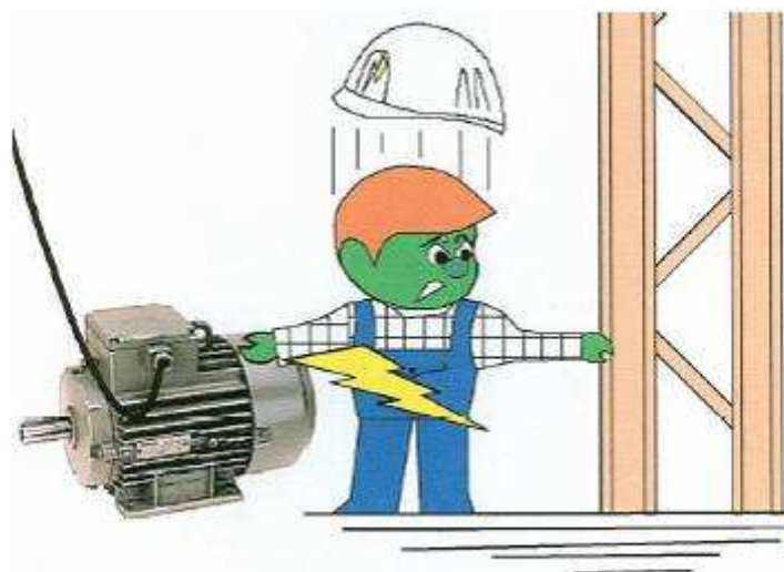
Εικόνα 4.41 Κίνδυνος ηλεκτροπληξίας από έλλειψη γείωσης
