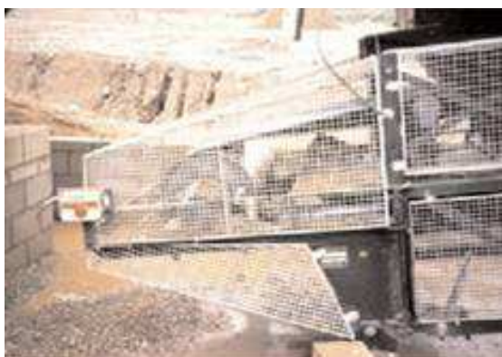
Εικόνα 4.23 Εγκατάσταση προστατευτικών καλυμμάτων σε ιμάντες κίνησης
