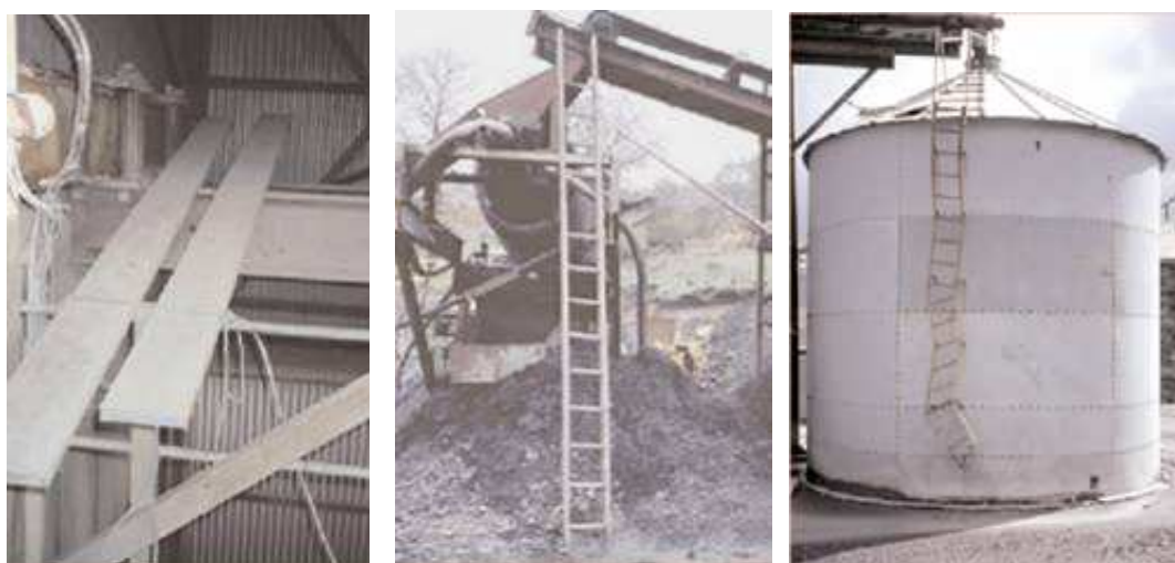
Εικόνα 3.38. Κίνδυνος τραυματισμού από αυτοσχέδιες εξέδρες και επικίνδυνες σκάλες [27]
