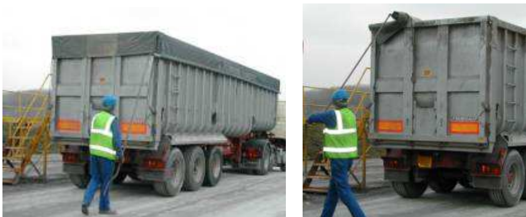
Εικόνα 4.18 Χειρισμός καλύμματος από το έδαφος με ιμάντες
