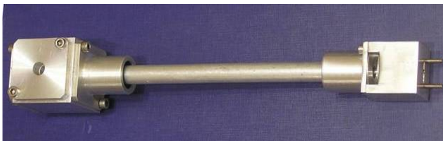
Εικόνα 2.6 Το πρότυπο οπτικό μικρόφωνο όπως αρχικά κατασκευάστηκε
