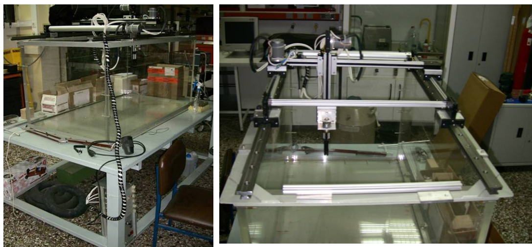
Εικόνα 2.16 Απόψεις τις δεξαμενής και του αυτοματοποιημένου συστήματος μετακίνησης
