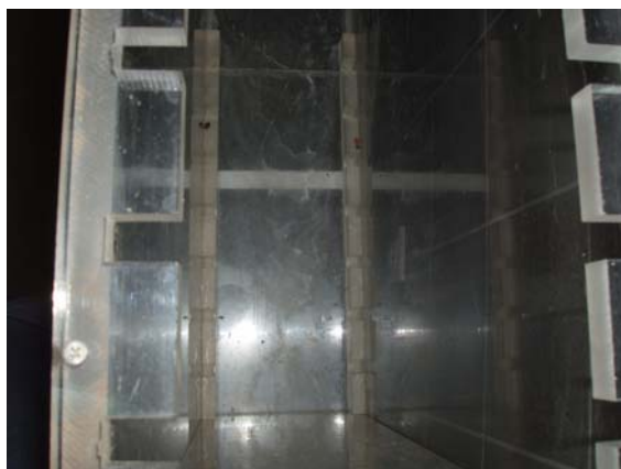
Εικόνα 4-9: «Δόντια» αγκίστρωσης της πλάκας
