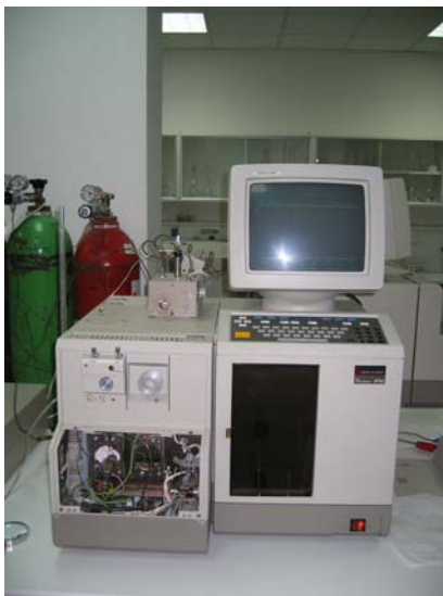
Εικόνα 7-10: Αέριος Χρωματογράφος Perkin Elmer 8700
