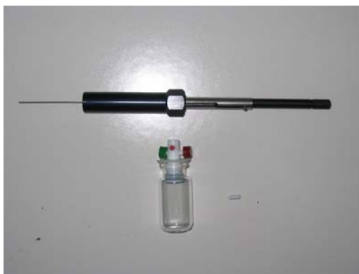
Εικόνα 7-9: Ίνα, δοχείο ανάλυσης, μαγνητικός αναδευτήρας
