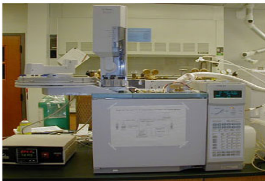
Εικόνα 7-6: Φωτογραφία ενός αέριου χρωματογράφου (Πηγή: www.dartmouth.edu )
