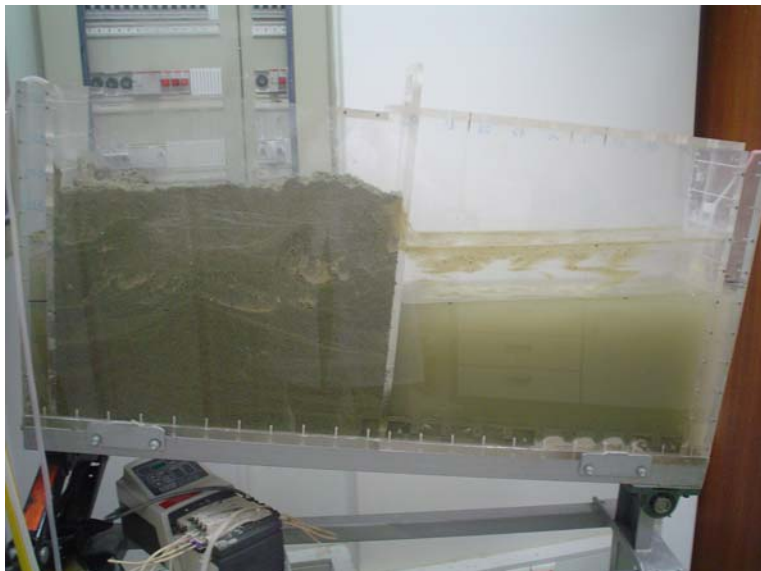
Εικόνα 4-10: Διάρθρωση της δεξαμενής με χρήση της διαχωριστικής πλάκας
