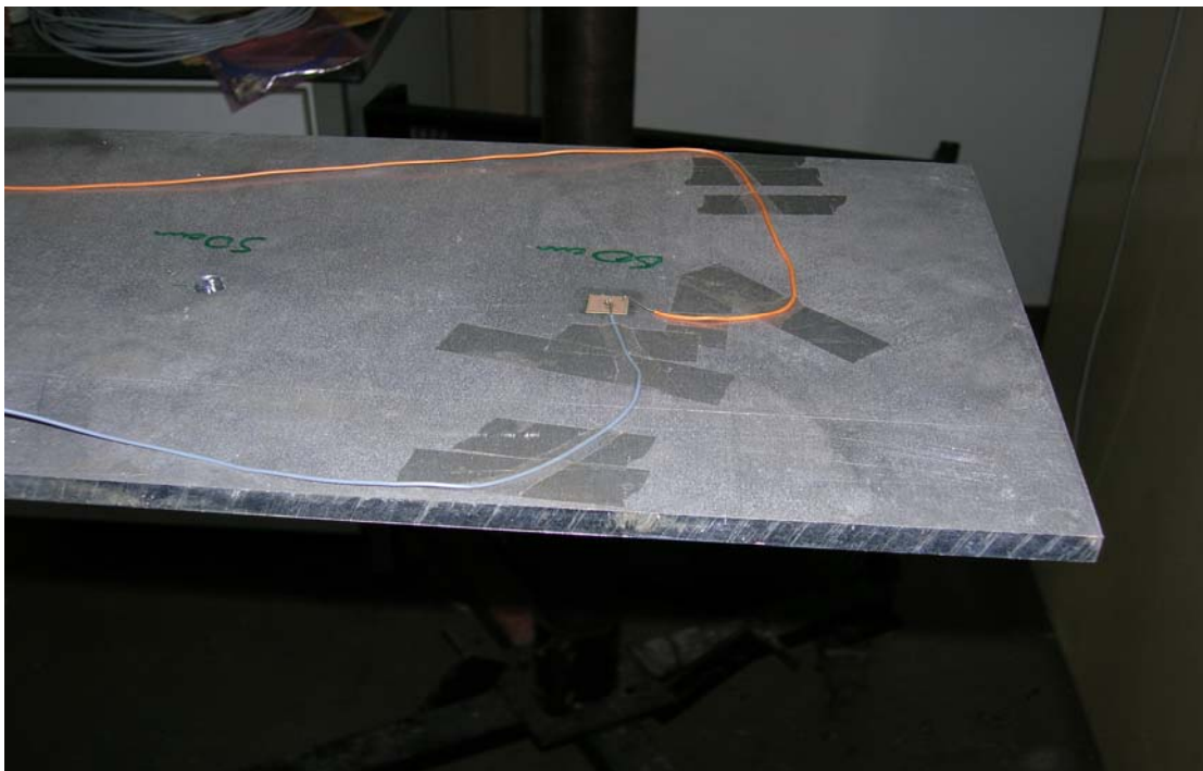
Εικόνα 49 Το πιεζοηλεκτρικό πάνω στην μεταλλική πλάκα
