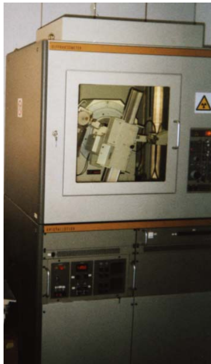
Εικόνα 6. 1: Περιθλασίμετρο ακτίνων-Χ, τύπου D500 της Siemens, του Εργαστηρίου Γενικής και Τεχνικής Ορυκτολογίας
