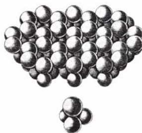
Σχήμα 1.2: Μοντέλο τετραεδρικής στοιβάδας και τετραέδρου πυριτίου-οξυγόνου [Van Olphen, 1977].
