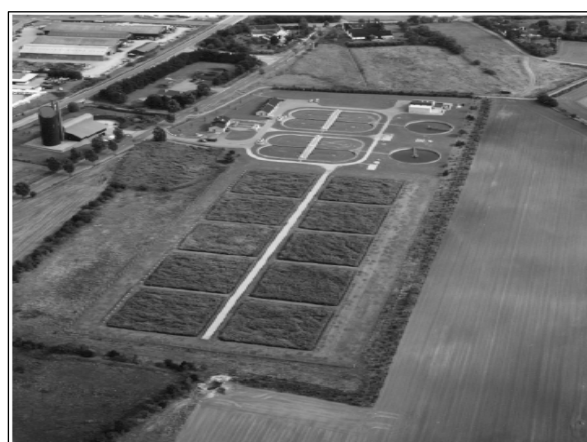
Εικόνα. Ε.3. α) Κλίνες αποξήρανσης ιλύος (Αγγελάκης et al., 2004) β) Σύστημα κλινών ξήρανσης με καλάμια που καθιερώθηκε τον Οκτώβριο του 1996 στη Δανία (S. Nielsen et al.)
