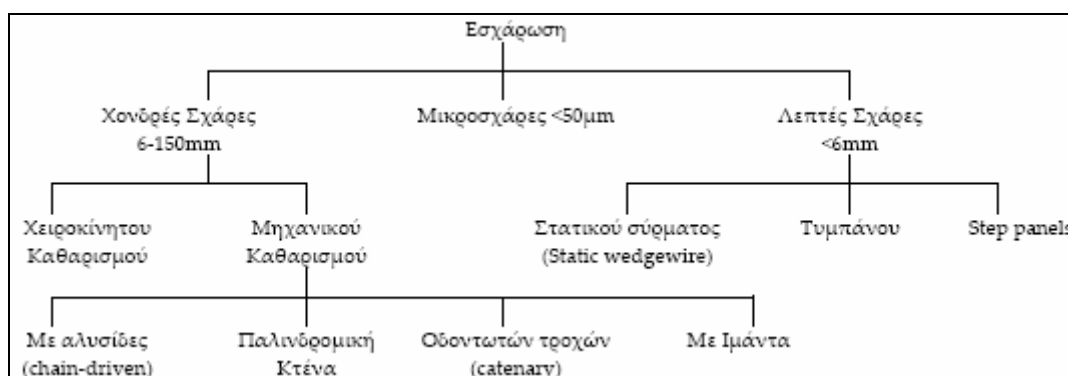
Σχήμα E.1. Τύποι σχαρών που χρησιμοποιούνται στην επεξεργασία των υγρών αποβλήτων
