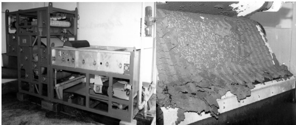
Εικόνα Ε.4. Ταινιοφιλτρόπρεσσες: (α) Γενική άποψη και (β) αφυδατωμένη ιλύς
