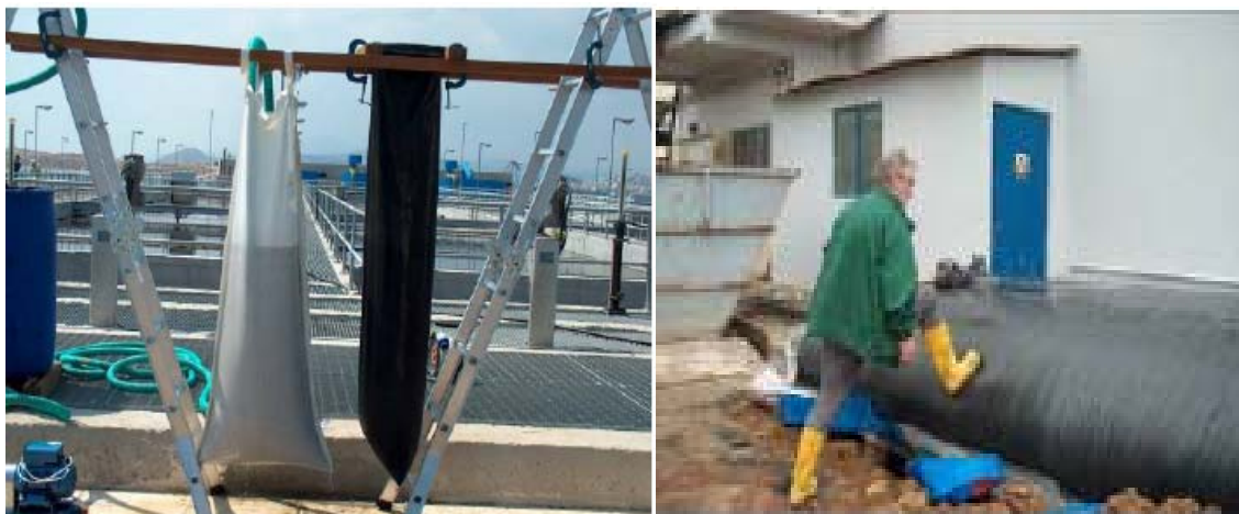
Εικόνα Ε.8. (α) Αποστράγγιση με τη μέθοδο των γαιόσακων (β) Η διαδικασία αποστράγγισης εντείνεται κάτω από την παραμικρή πίεση (GEO ACTIONS, 2005)
