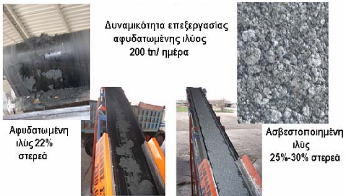
Εικόνα Ε.12. Από την Ασβεστοποίηση ιλύος ΕΕΛ Σίνδου – Δοκιμές πεδίου (Α. Ανδρεαδάκης et al., 2005)
