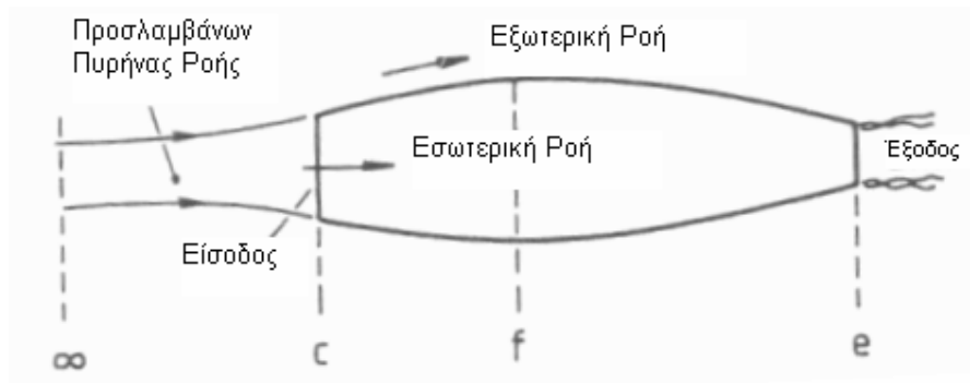
Εικόνα 1.1: Κύριες περιοχές της ροής σε αεραγωγό [Seddon et al., 1993]
