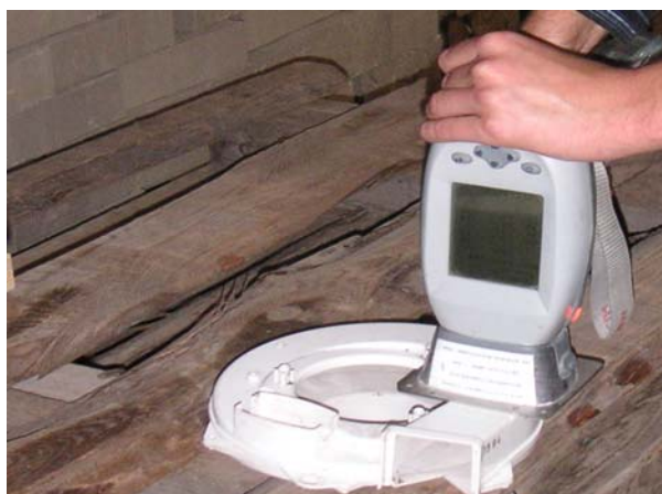
Εικόνα 15: Διεξαγωγή των μετρήσεων με το φορητό XRF.
