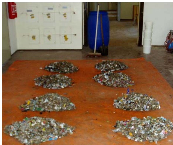
Εικόνα 11: Δειγματοληψία ποσότητας MSW >10 mm.
