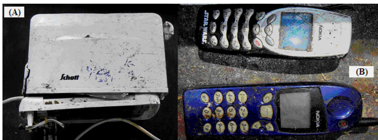
Εικόνα 9: (Α) Ζημία λόγω πιθανής συμπίεσης στο απορριμματοφόρο & (Β) Κινητά τηλέφωνα με βαθμό ζημίας 1.
