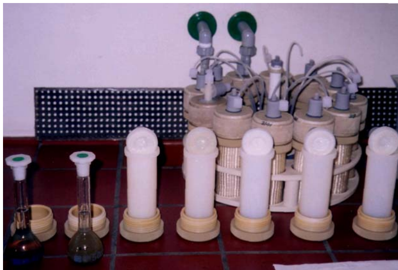
Εικόνα 12: Μεταφορά των χωνεμένων διαλυμάτων σε ογκομετρικές φιάλες.
