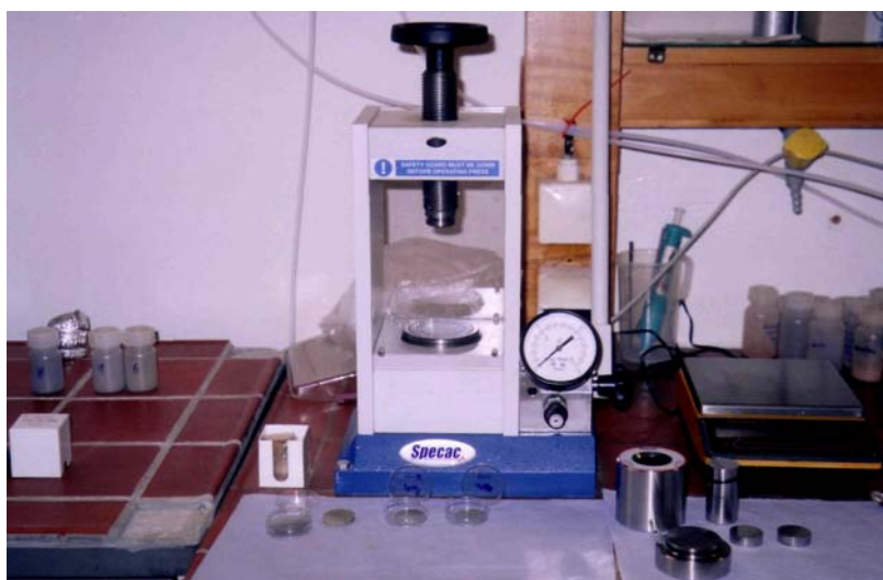
Εικόνα 14: Παρασκευή των ταμπλέτων για το EDXRF.
