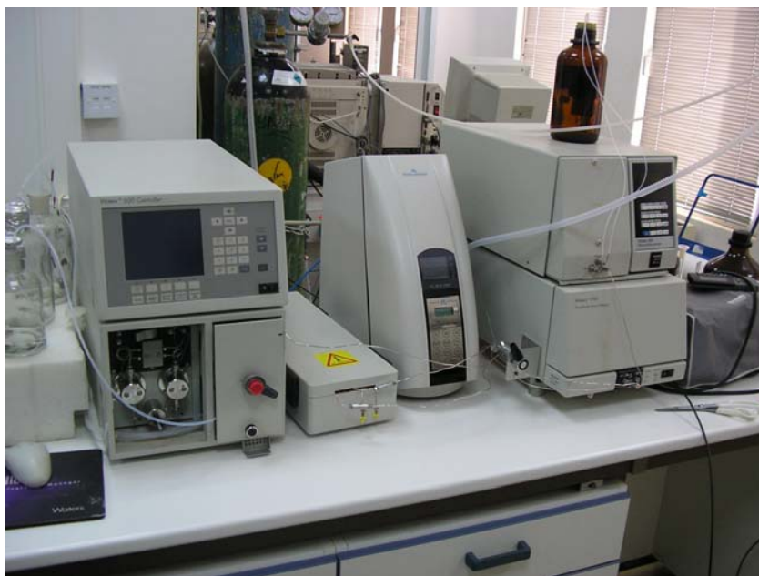
Εικόνα 3.1: Σύστημα υγρής χρωματογραφίας υψηλής πίεσης
