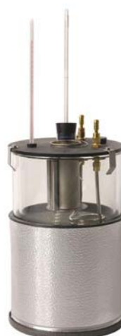
Εικόνα 1.2: Διάταξη μέτρησης του σημείου ροής και του σημείου θολώσεως
