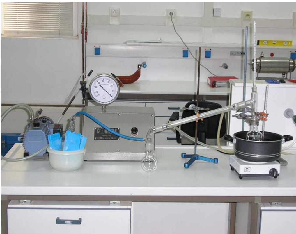
Εικόνα 3.10: Φωτογραφία διάταξης απόσταξης υπό κενό
