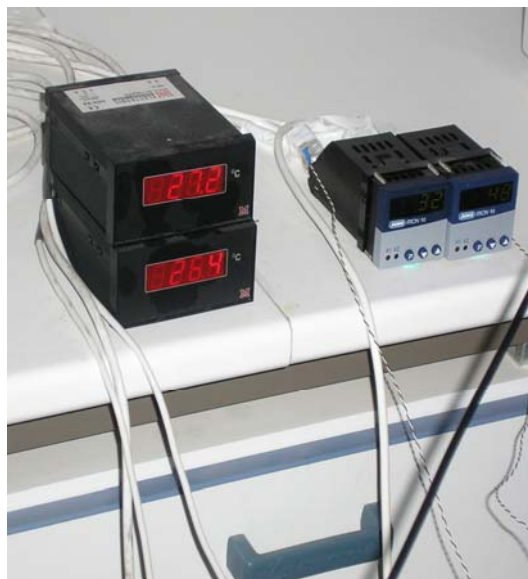
Εικόνα 3.6: Θερμοστοιχεία ελέγχου θερμοκρασίας του εκχυλιστήρα και ελεγκτές θερμοστάτησης των δοχείων θέρμανσης διαλύτη και ορυκτελαίου
