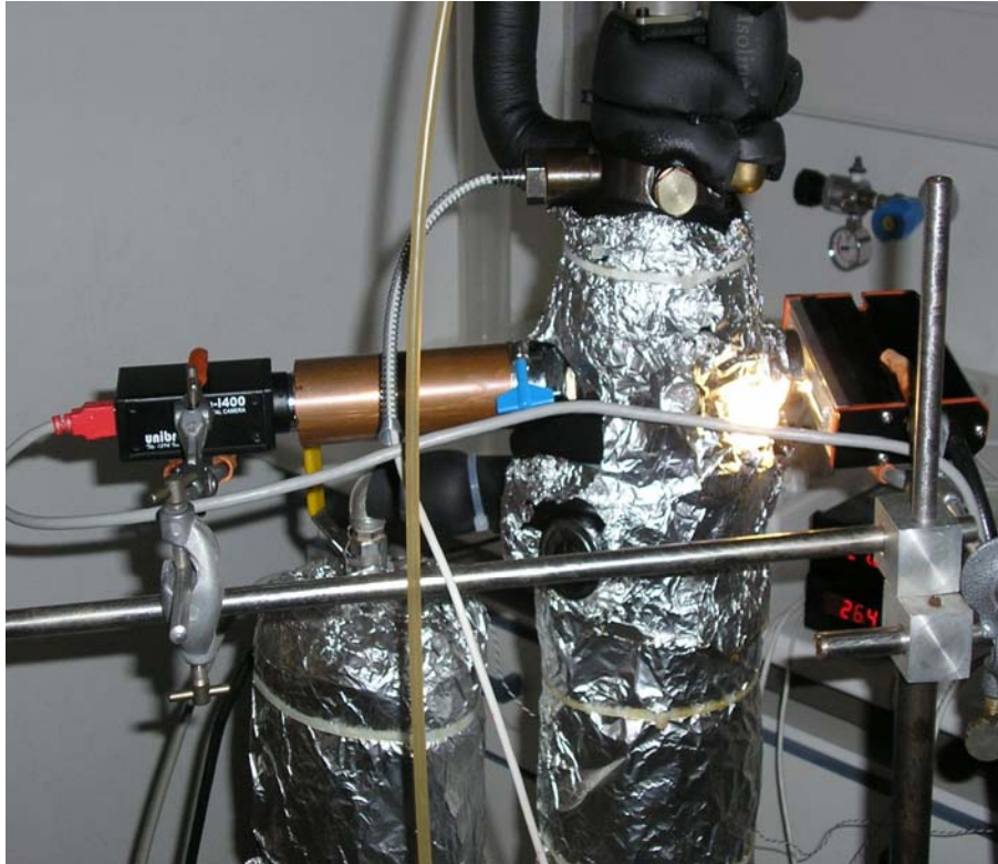
Εικόνα 3.7: Σύστημα οπτικής παρακολούθησης της διεπιφάνειας
