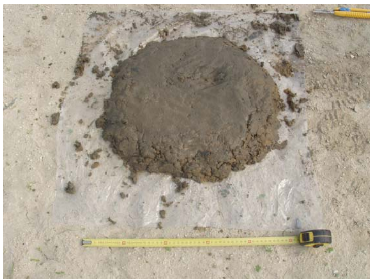
Εικόνα Γ.3: Συλλογή εδαφικού υλικού και λήψη αντιπροσωπευτικού δείγματος (Δείγμα W5)
