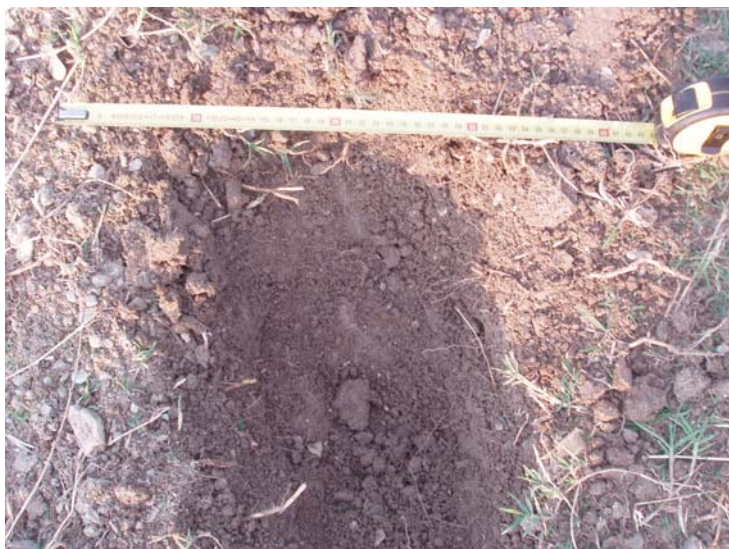
Εικόνα Γ.7: Λάκκος δειγματοληψίας εδαφικού υλικού (Δείγμα W10)
