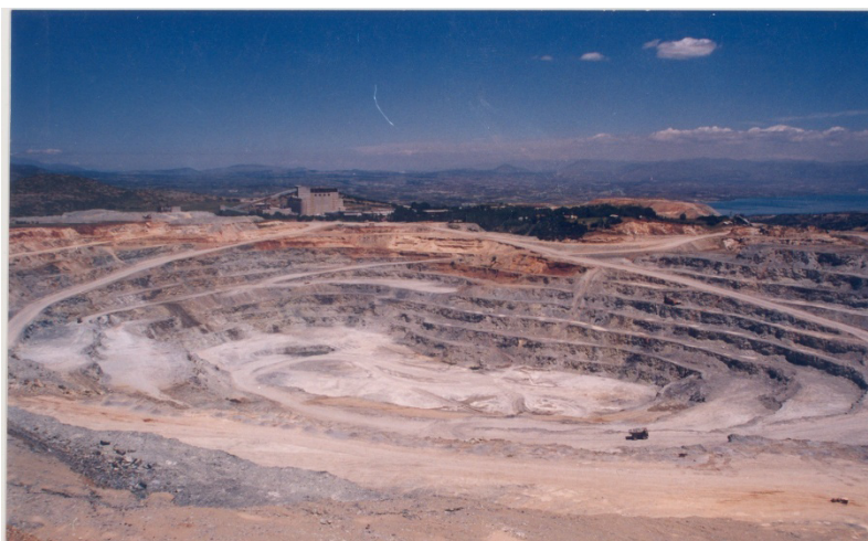
Εικόνα 6.3: Χώρος εξόρυξης με τη μέθοδο των ορθών βαθμίδων
