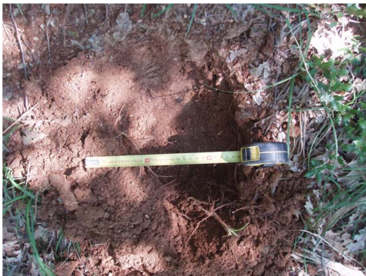
Εικόνα Γ.4: Λάκκος δειγματοληψίας εδαφικού υλικού (Δείγμα W9)
