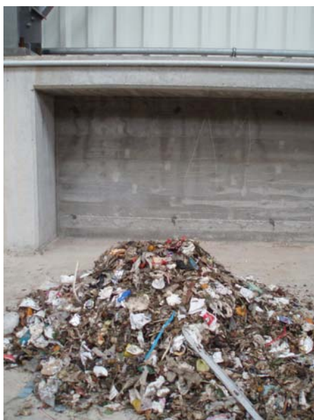
Εικόνα 11 Σωρός Β Οργανικό Κλάσμα Αστικών Απορριμμάτων και μείγμα Βιολογικής Ιλύος (Χωνεμένης και Αχώνευτης) σε αναλογία 2:1
