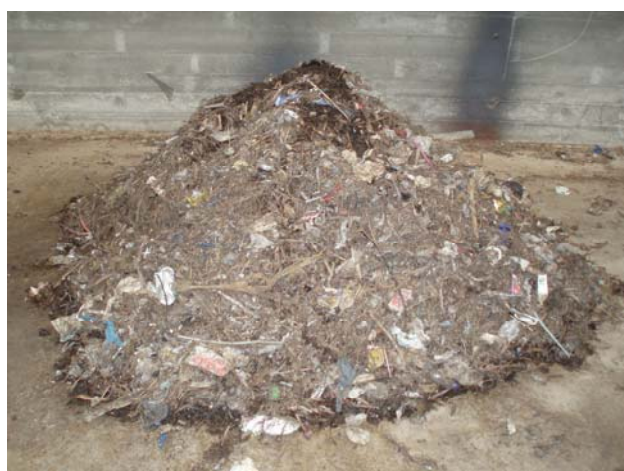
Εικόνα 6 Σωρός D την δεύτερη ημέρα της διεργασίας. Παρατηρείτε στην κορυφή του σωρού οι ατμοί που εξέρχονται από αυτόν
