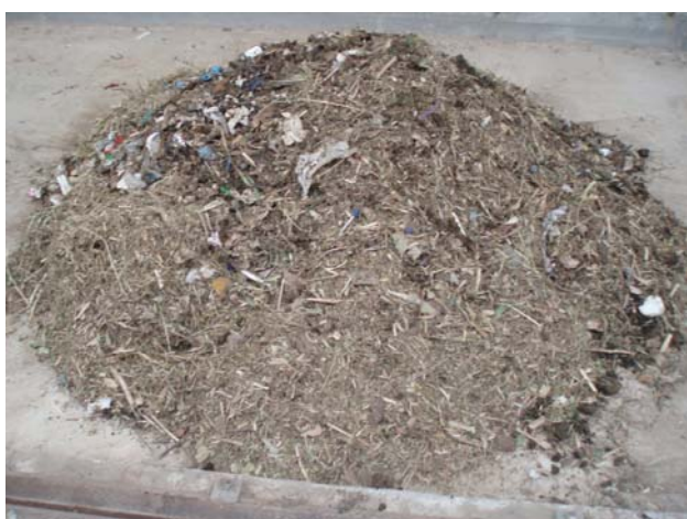
Εικόνα 5 Σωρός D με Οργανικό Κλάσμα Αστικών Απορριμμάτων, μείγμα Βιολογικής Ιλύος (Χωνεμένης και Αχώνευτης) και Φυτικά Υπολείμματα σε αναλογίες 4:1:2 κατά βάρος
