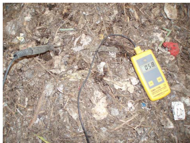
Εικόνα 10 Συσκευή μέτρηση εσωτερικής θερμοκρασίας των σωρών
