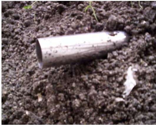
Εικόνα 7: Δειγματολήπτης εντός του σωρού SDN -Δειγματοληψίας στιγμιαίου δείγματος
