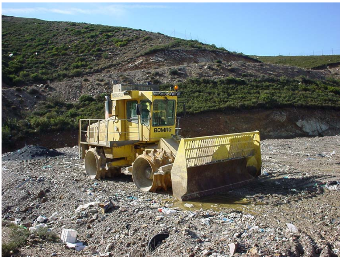
Εικόνα 38. Ειδικό όχημα συμπίεσης απορριμμάτων (κατσκοπόδαρος).
