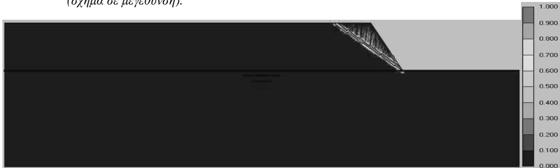
Σχήμα 50: Κατανομή των σχετικών διατμητικών τάσεων στη μάζα του προτύπου για την 17 η περίπτωση επίλυσης της παραμετρικής ανάλυσης.
