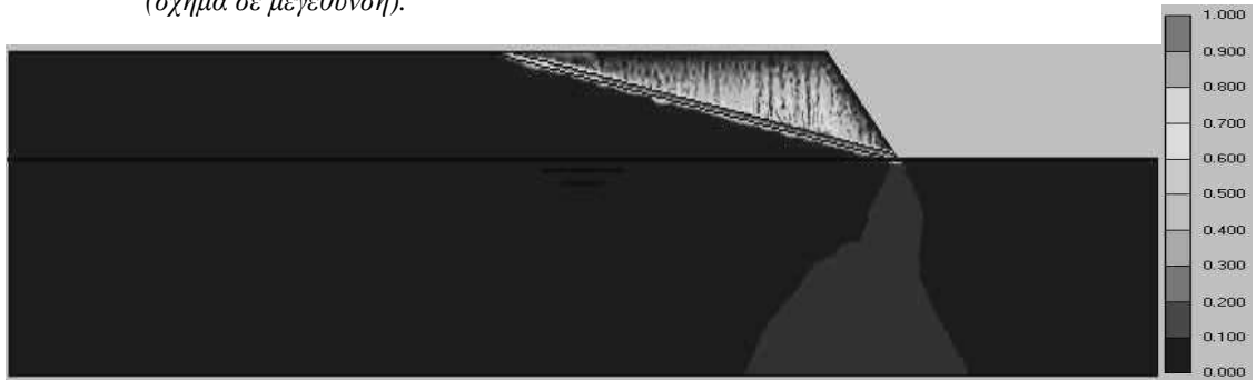
Σχήμα 41: Κατανομή των σχετικών διατμητικών τάσεων στη μάζα του προτύπου για την 14 η περίπτωση επίλυσης της παραμετρικής ανάλυσης.
