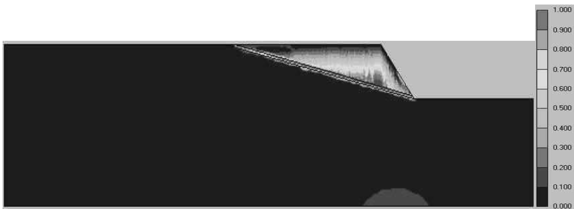
Σχήμα 5: Κατανομή των σχετικών διατμητικών τάσεων στη μάζα του προτύπου για την 2 η περίπτωση επίλυσης της παραμετρικής ανάλυσης.
