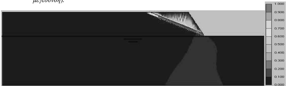
Σχήμα 95: Κατανομή των σχετικών διατμητικών τάσεων στη μάζα του προτύπου για την 8 η περίπτωση σύνθετης επίλυσης.
