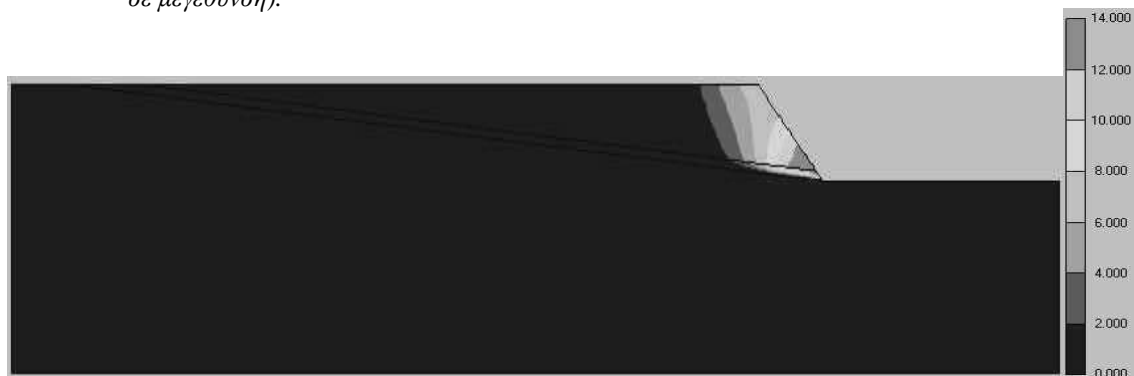
Σχήμα 20: Ολικές μετατοπίσεις της 7 ης περίπτωσης επίλυσης της παραμετρικής ανάλυσης (υπόμνημα σε m).
