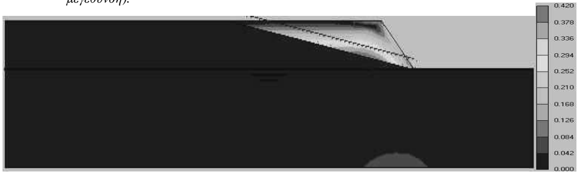
Σχήμα 86: Κατανομή των σχετικών διατμητικών τάσεων στη μάζα του προτύπου για την 5 η περίπτωση σύνθετης επίλυσης.
