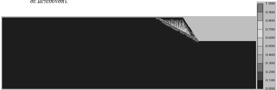
Σχήμα 11: Κατανομή των σχετικών διατμητικών τάσεων στη μάζα του προτύπου για την 4 η περίπτωση επίλυσης της παραμετρικής ανάλυσης.
