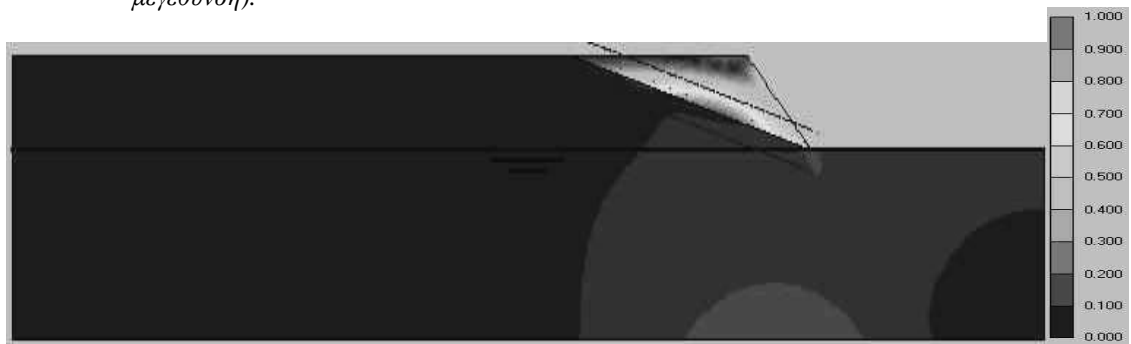
Σχήμα 89: Κατανομή των σχετικών διατμητικών τάσεων στη μάζα του προτύπου για την 6 η περίπτωση σύνθετης επίλυσης.
