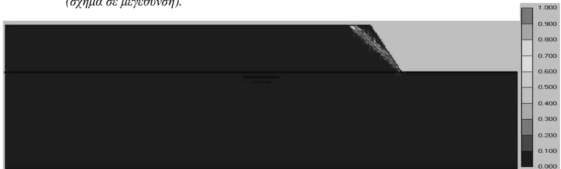
Σχήμα 71: Κατανομή των σχετικών διατμητικών τάσεων στη μάζα του προτύπου για την 24 η περίπτωση επίλυσης της παραμετρικής ανάλυσης.
