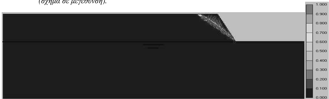
Σχήμα 68: Κατανομή των σχετικών διατμητικών τάσεων στη μάζα του προτύπου για την 23 η περίπτωση επίλυσης της παραμετρικής ανάλυσης.
