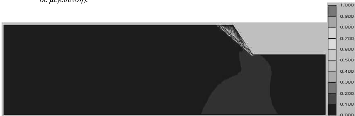
Σχήμα 17: Κατανομή των σχετικών διατμητικών τάσεων στη μάζα του προτύπου για την 6 η περίπτωση επίλυσης της παραμετρικής ανάλυσης.
