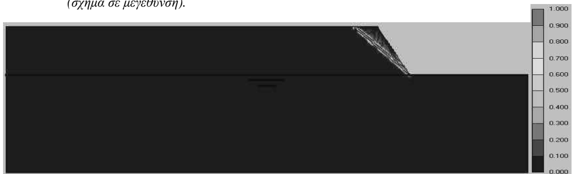
Σχήμα 53: Κατανομή των σχετικών διατμητικών τάσεων στη μάζα του προτύπου για την 18 η περίπτωση επίλυσης της παραμετρικής ανάλυσης.
