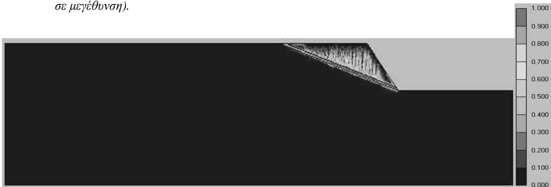
Σχήμα 8: Κατανομή των σχετικών διατμητικών τάσεων στη μάζα του προτύπου για την 3 η περίπτωση επίλυσης της παραμετρικής ανάλυσης.
