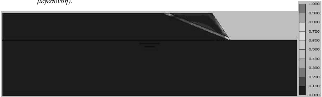
Σχήμα 92: Κατανομή των σχετικών διατμητικών τάσεων στη μάζα του προτύπου για την 7 η περίπτωση σύνθετης επίλυσης.
