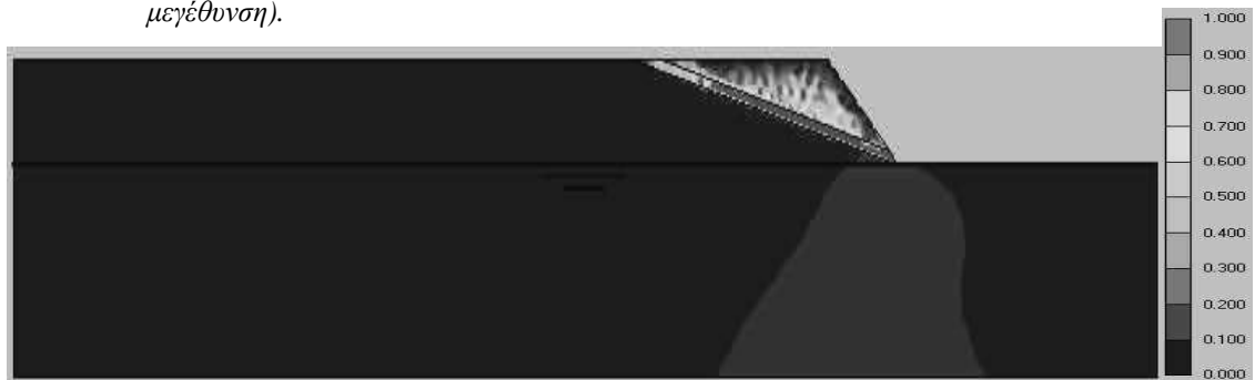
Σχήμα 98: Κατανομή των σχετικών διατμητικών τάσεων στη μάζα του προτύπου για την 9 η περίπτωση σύνθετης επίλυσης.
