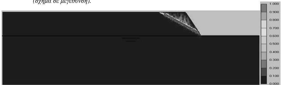
Σχήμα 65: Κατανομή των σχετικών διατμητικών τάσεων στη μάζα του προτύπου για την 22 η περίπτωση επίλυσης της παραμετρικής ανάλυσης.
