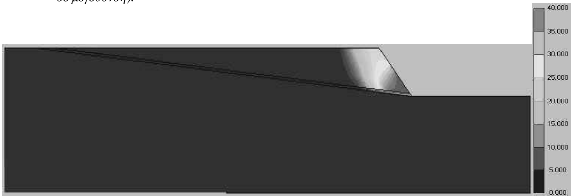
Σχήμα 2: Ολικές μετατοπίσεις της 1 ης περίπτωσης επίλυσης της παραμετρικής ανάλυσης (υπόμνημα σε m).
