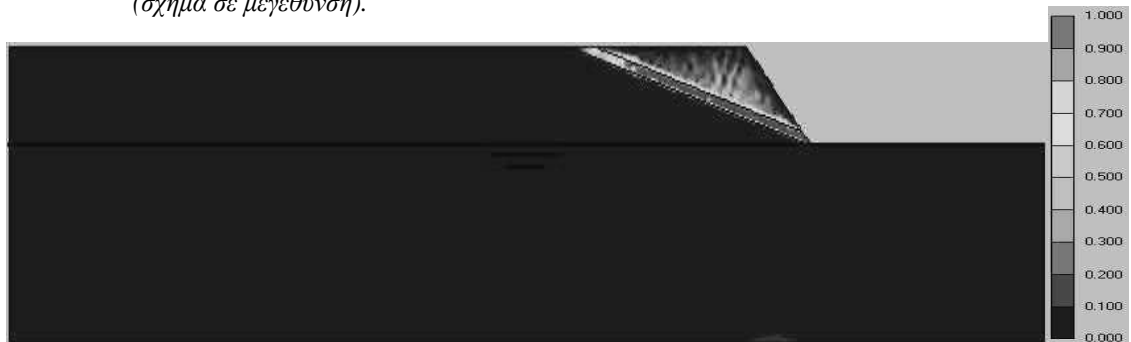
Σχήμα 62: Κατανομή των σχετικών διατμητικών τάσεων στη μάζα του προτύπου για την 21 η περίπτωση επίλυσης της παραμετρικής ανάλυσης.
