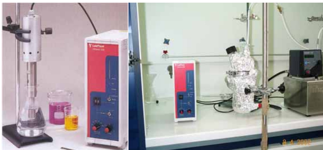
Σχήμα 16: Φωτογραφίες του αντιδραστήρα υπερήχων με ηχόδιο που χρησιμοποιήθηκε στην παρούσα μελέτη.
