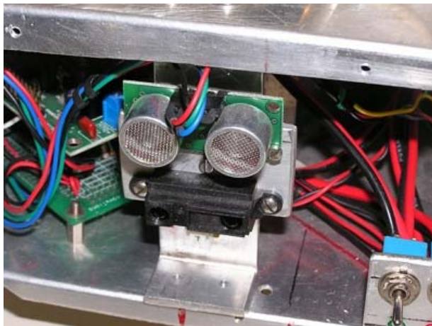
Εικόνα 6.3: Η τοποθέτηση του αισθητήρα SRF-04 στη ράβδο στήριξης της οροφής.
