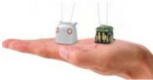
Εικόνα 2.34: Το ρομποτικό όχημα Monsieur II-p, που περιλαμβάνει έναν πολύ περιορισμένων διαστάσεων μικροελεγκτή της Seiko Epson Corp
