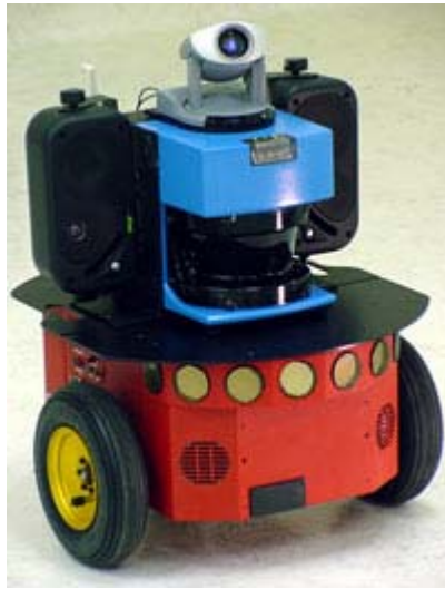
Εικόνα 2.51: Το ρομποτικό όχημα PIONEER 3-DX της ACTIVMEDIA εφοδιασμένο με έναν σαρωτή λέιζερ
