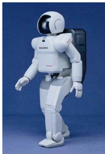
Εικόνα 2.17: Το δίποδο ανθρωπόμορφο ρομπότ ASIMO, με άκρα έξι βαθμών ελευθερίας και δυναμική ισορροπία
