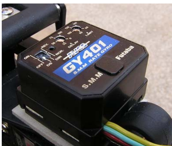
Εικόνα 2.54: Γυροσκόπιο GY401 της Futaba
