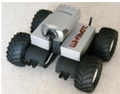
Εικόνα 2.10: Το WIFIBOT βάρους 4,5 kgr. Φέρει ελαστικούς τροχούς χωρίς αεροθαλάμους, διαμέτρου 10cm.
