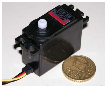
Εικόνα 2.30: Το σέρβο HS422 της Hitec
