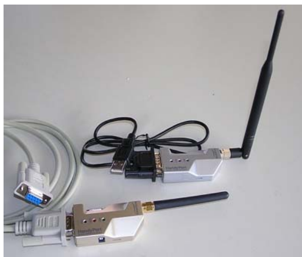
Εικόνα 2.39: Ασύρματες συσκευές επικοινωνίας που συνδέονται στη σειριακή θύρα και στη θύρα USB
