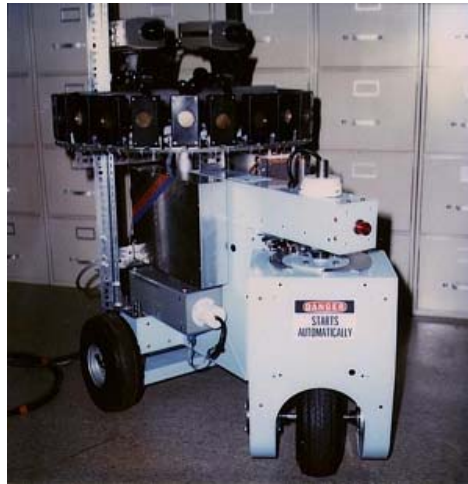
Εικόνας 2.20: Το ρομποτικό όχημα NEPTUNE με δύο πίσω τροχούς και έναν κινητήριο και κατευθυντήριο εμπρός.
