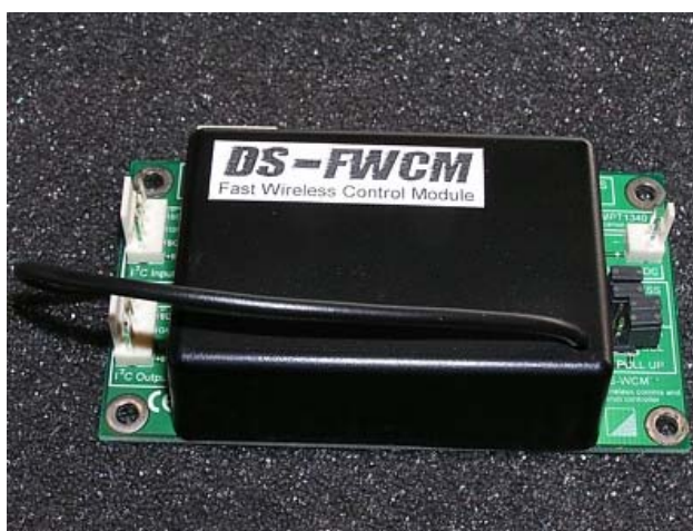
Εικόνα 2.40: Η συσκευή απευθείας επικοινωνίας FWCM
