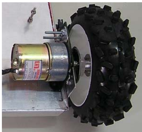
Εικόνας 2.27: Σερβοκινητήρας με κιβώτιο μείωσης της σχέσης μετάδοσης
