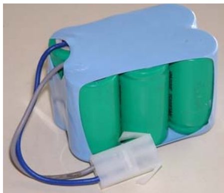
Εικόνα 2.43: Συσσωρευτής NiMH των 7.2V, 3000mAh που προέκυψε από σύνδεση σε σειρά έξι μονάδων των 1.2V, 3000mAh
