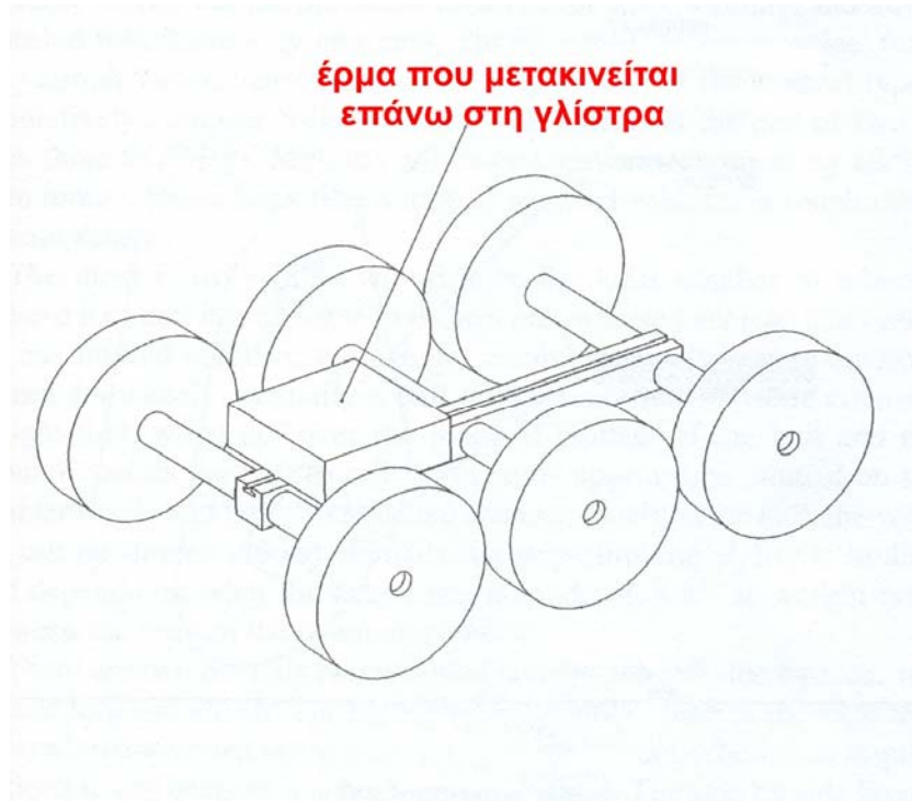
Εικόνα 2.5: Σύστημα μετακίνησης του κέντρου βάρους του οχήματος
