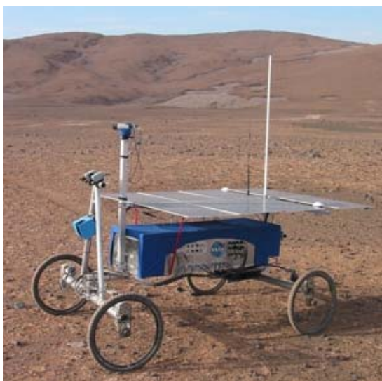
Εικόνας 2.22: Το ρομποτικό όχημα HYPERION με τετραδιεύθυνση και τετρακίνηση.
