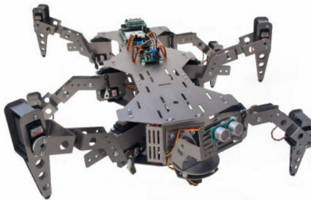
Εικόνα 2.16: Το εξάποδο ρομπότ HEXCRAWLER HDATS, με άκρα τριών βαθμών ελευθερίας και στατική ισορροπία
