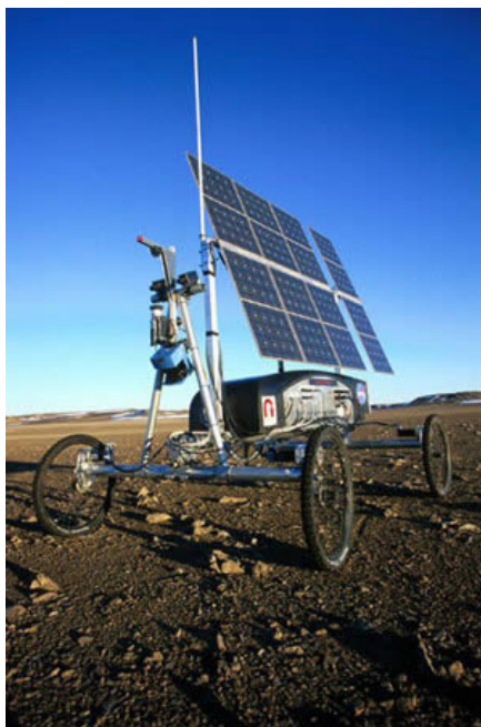
Εικόνα 2.42: Το ρομποτικό όχημα HYPERION που τροφοδοτείται από ηλιακή ενέργεια.
