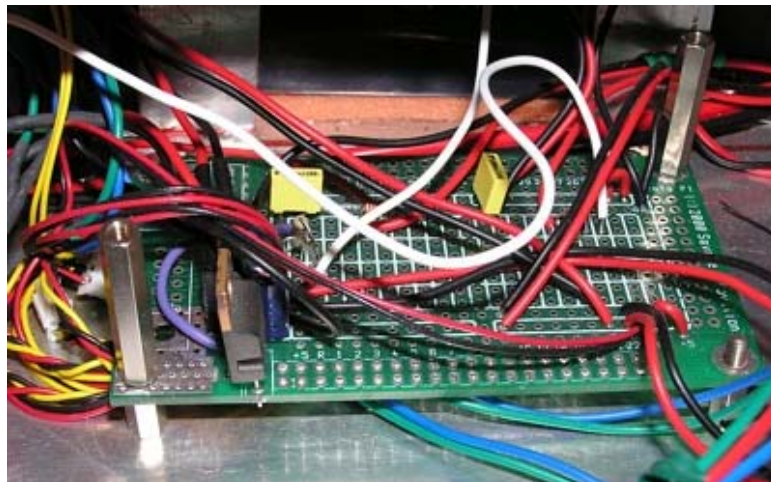
Εικόνα 5.4: Η ηλεκτρονική πλακέτα βοηθητικών κυκλωμάτων του ΑΛΕ
