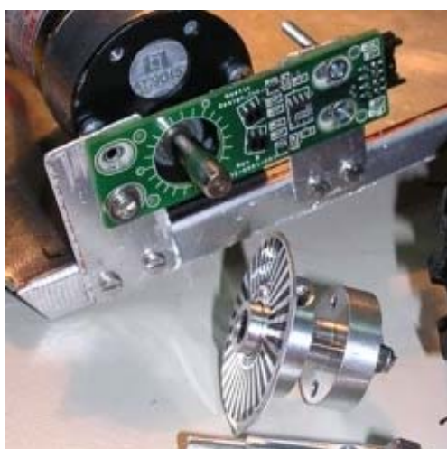
Εικόνα 6.6: Το οδόμετρο WW-01 τοποθετημένο σε κινητήρα του ΑΛΕ
