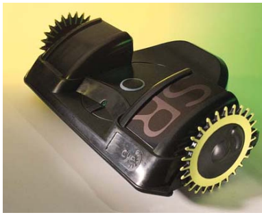
Εικόνας 2.19: Το ρομποτικό όχημα CYE με δύο κινητήριους τροχούς και κέντρο βάρους χαμηλότερα από τον άξονά τους.
