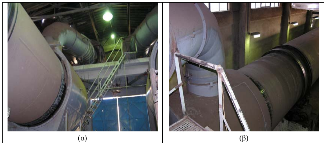
Εικόνα 13: α) Ο απορροφητήρας του ξηραντηρίου και β) το σημείο σύνδεσής του με τον κύλινδρο ξήρανσης.
