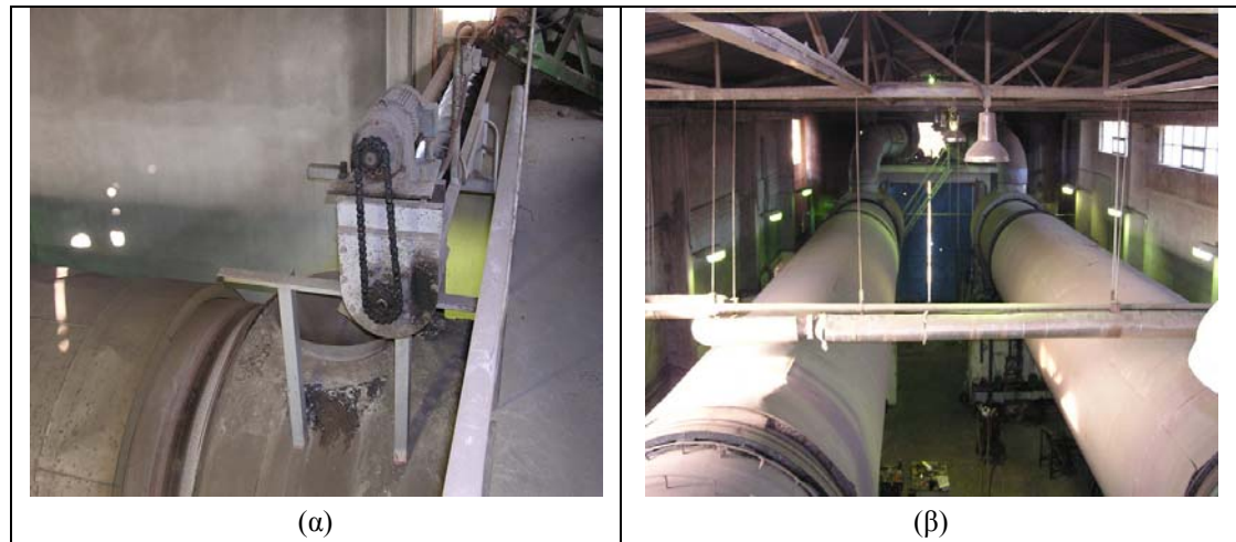
Εικόνα 11: α) Ο τρόπος εισαγωγής του ελαιοπυρήνα στον περιστρεφόμενο κύλινδρο, β) τα δύο ξηραντήρια της Α.Β.Ε.Α.
