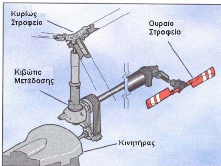
Εικόνα 2.2: Η μετάδοση της κίνησης από τον κινητήρα προς τα στροφεία
