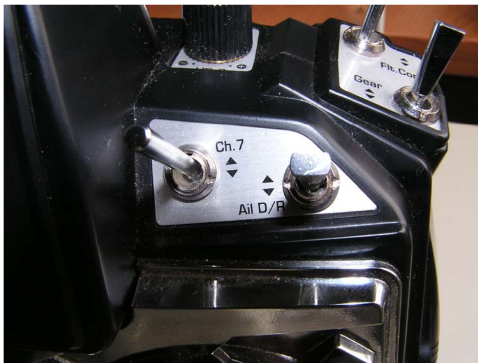
Εικόνα 4.12: Διακόπτης καναλιού 7 στη θέση manual
