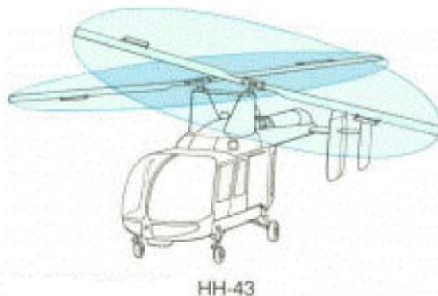
Εικόνα 2.9: Διάταξη με πεπλεγμένα στροφεία
