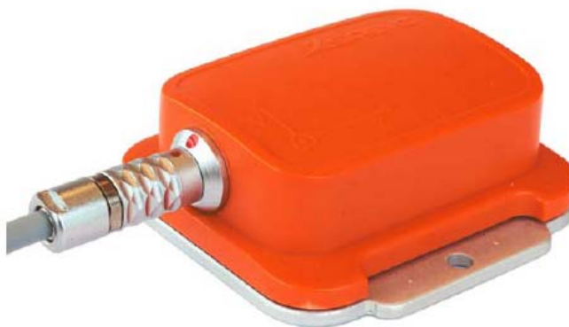
Εικόνα 4.6: Η αδρανειακή μονάδα μέτρησης
