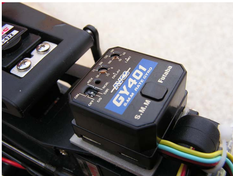
Εικόνα 3.12: Το GY401 τοποθετημένο στο ελικόπτερο Raptor 60
