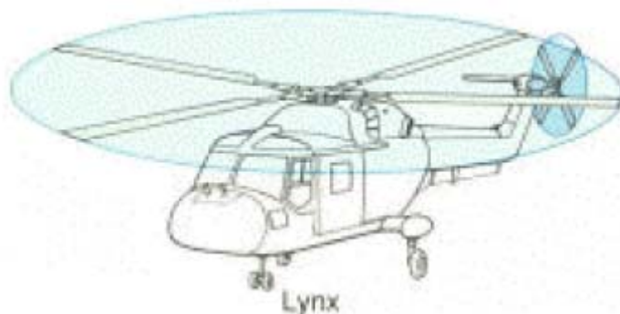
Εικόνα 2.6: Διάταξη κυρίως στροφείου σε συνδυασμό με ουραίο στροφείο.
