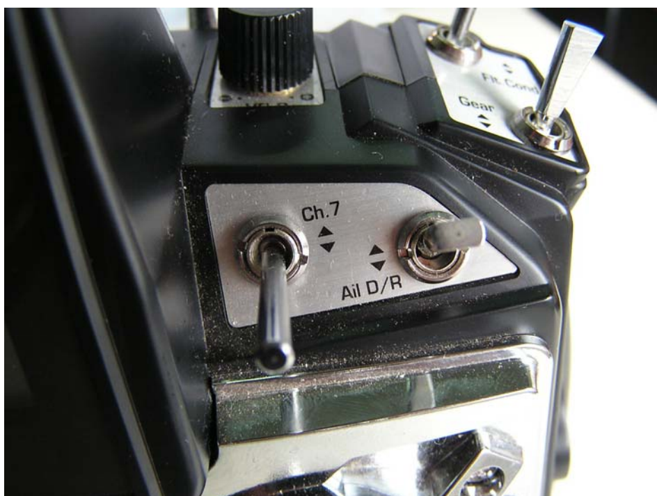
Εικόνα 4.13: Διακόπτης καναλιού 7 στη θέση auto
