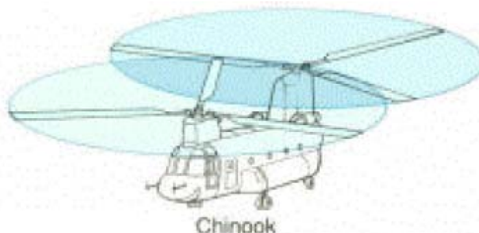
Εικόνα 2.7: Διάταξη δίδυμων στροφείων
