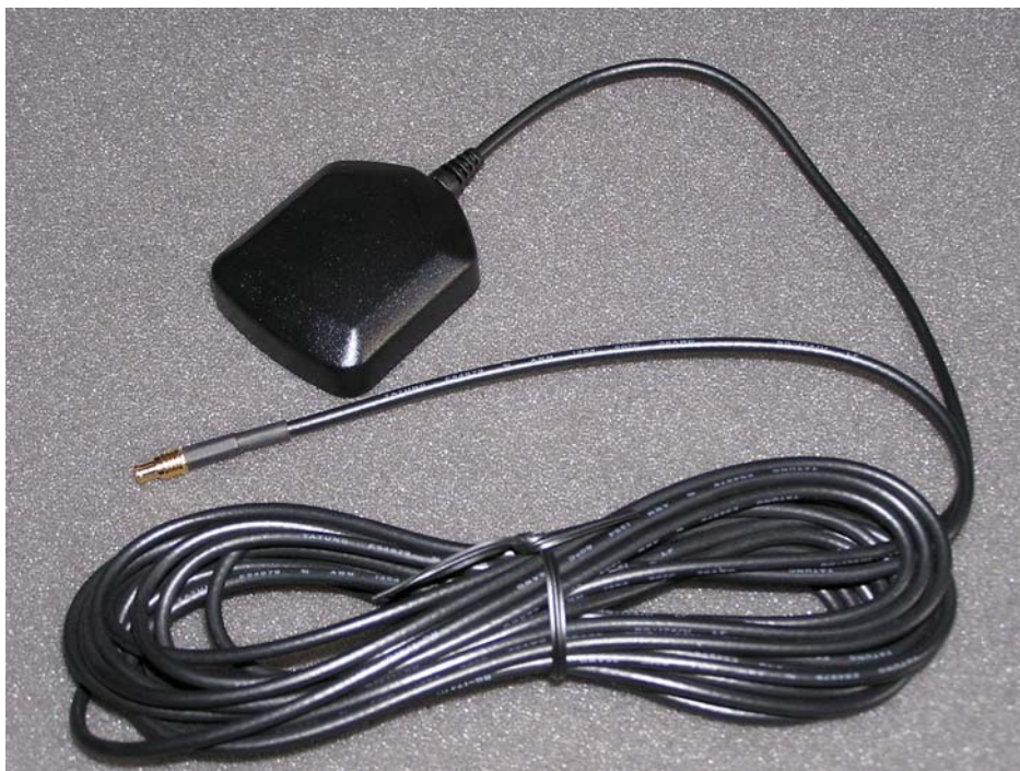
Εικόνα 4.5: Η κεραία του δέκτη GPS
