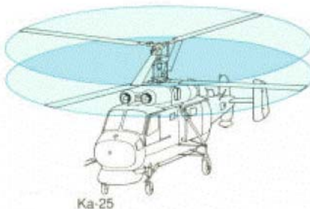
Εικόνα 2.10: Διάταξη με δύο ομοαξονικά στροφεία.
