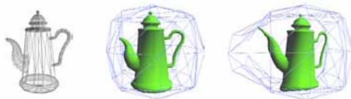
Σχήμα 1.20: Η τσαγιέρα (αριστερό σχήμα) τοποθετείται εντός πεδίου, που ορίζεται από δυναμικές spline - πεπλεγμένες συναρτήσεις (μεσαίο σχήμα) και παραμορφώνεται με την μετακίνηση των σημείων ελέγχου του πεδίου (κορυφές) (δεξιό σχήμα) [Hua and Qin, 2003].
