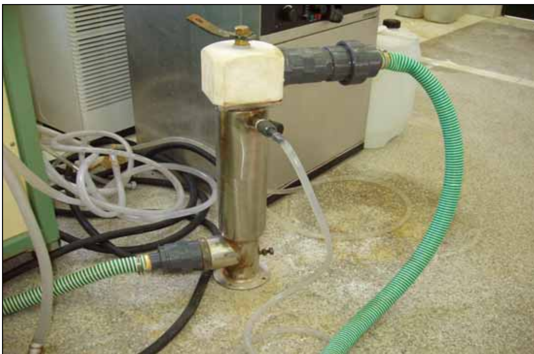
Σχήμα 55: Φωτογραφία ηλεκτρολυτικού κελιού
