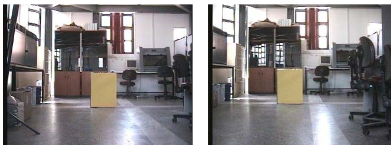
Σχήμα 5.5.2 Πραγματική απόσταση του αντικειμένου 425cm, υπολογιζόμενη 432cm
