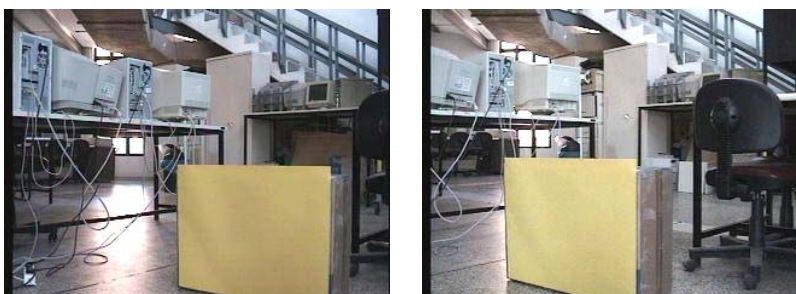
Σχήμα 5.5.5 Πραγματική απόσταση δεξιάς ακμής του αντικειμένου 150cm, υπολογιζόμενη 144cm Πραγματική απόσταση της αριστερής ακμής του αντικειμένου 183cm, υπολογιζόμενη 178cm
