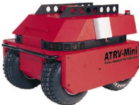
Σχήμα 3.1. Το έντροχο ρομποτικό όχημα ATRV-Mini
