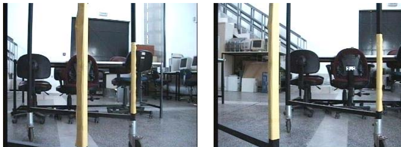
Σχήμα 5.4.14 Πραγματική απόσταση δεξιού αντικειμένου 148cm, υπολογιζόμενη 147cm Πραγματική απόσταση αριστερού αντικειμένου 78cm, υπολογιζόμενη 78cm
