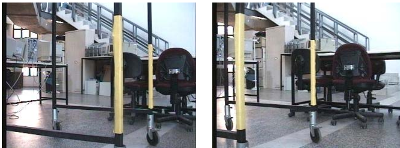
Σχήμα 5.5.8 Πραγματική απόσταση δεξιού αντικειμένου 178cm, υπολογιζόμενη 174cm Πραγματική απόσταση αριστερού αντικειμένου 95cm, υπολογιζόμενη 91cm
