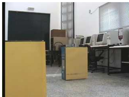
Σχήμα 5.6.10 Η απόσταση του πρώτου εμποδίου είναι μικρότερη των 180cm. Αποφασίζεται κίνηση προς αριστερά.
