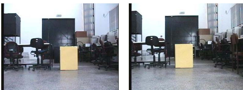
Σχήμα 5.5.4 Πραγματική απόσταση του αντικειμένου 380cm, υπολογιζόμενη 382cm
