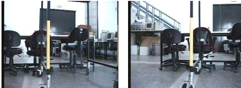
Σχήμα 5.5.13 Πραγματική απόσταση αντικειμένου 139cm, υπολογιζόμενη 139cm
