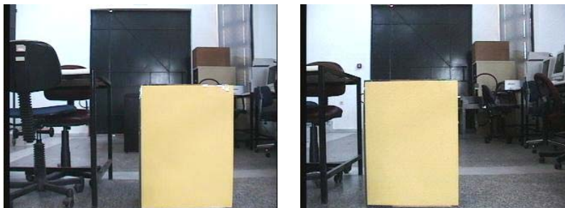
Σχήμα 5.5.3 Πραγματική απόσταση του αντικειμένου 166cm, υπολογιζόμενη 161cm
