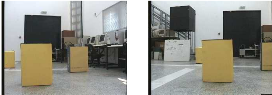
Σχήμα 5.6.8 Εντοπισμός των εμποδίων. Βρίσκονται μακριά και εξακολουθεί η ευθύγραμμη κίνηση
