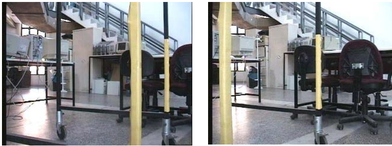
Σχήμα 5.5.7 Πραγματική απόσταση δεξιού αντικειμένου 153cm, υπολογιζόμενη 154cm Πραγματική απόσταση αριστερού αντικειμένου 73cm, υπολογιζόμενη 71cm
