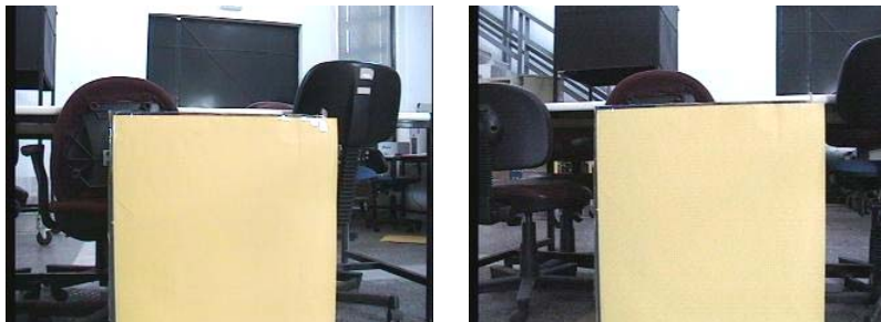
Σχήμα 5.5.11 Πραγματική απόσταση αντικειμένου 106cm, υπολογιζόμενη 103cm
