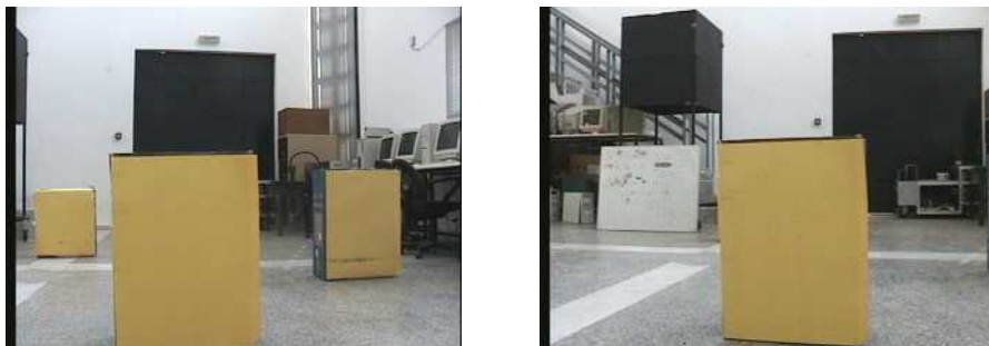
Σχήμα 5.6.10 Η απόσταση του πρώτου εμποδίου είναι μικρότερη των 180cm. Αποφασίζεται κίνηση προς αριστερά.
