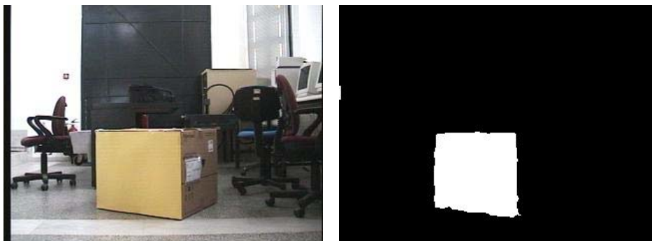
Σχήμα 4.5.3. Εφαρμογή τεχνικής κατωφλίου στο χρωματικό χώρο HSI
