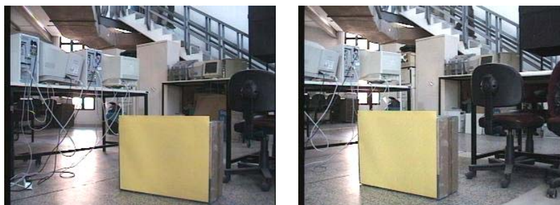
Σχήμα 5.5.6 Πραγματική απόσταση δεξιάς ακμής του αντικειμένου 180cm, υπολογιζόμενη 178cm Πραγματική απόσταση της αριστερής ακμής του αντικειμένου 215cm, υπολογιζόμενη 212cm
