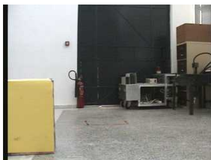
Σχήμα 5.6.14. Το τρίτο εμπόδιο βρίσκεται σε απόσταση μικρότερη των 180cm. Αποφασίζεται κίνηση προς τα δεξιά
