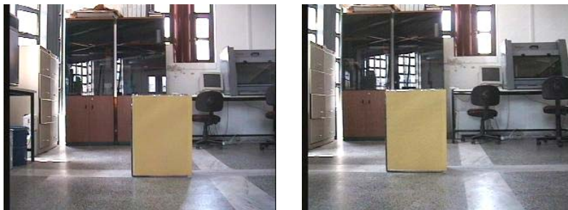
Σχήμα 5.5.1 Πραγματική απόσταση του αντικειμένου 259cm, υπολογιζόμενη 257cm
