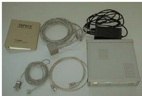
Σχήμα. 4.5. Το σύστημα προσδιορισμού θέσης και προσανατολισμού Fastrak της εταιρίας Polhemus.
