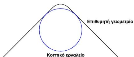
Σχήμα 3.53. Παράδειγμα γεωμετρίας που δεν μπορεί να κατασκευαστεί με το συγκεκριμένο κοπτικό εργαλείο, λόγω των γεωμετρικών του χαρακτηριστικών.
