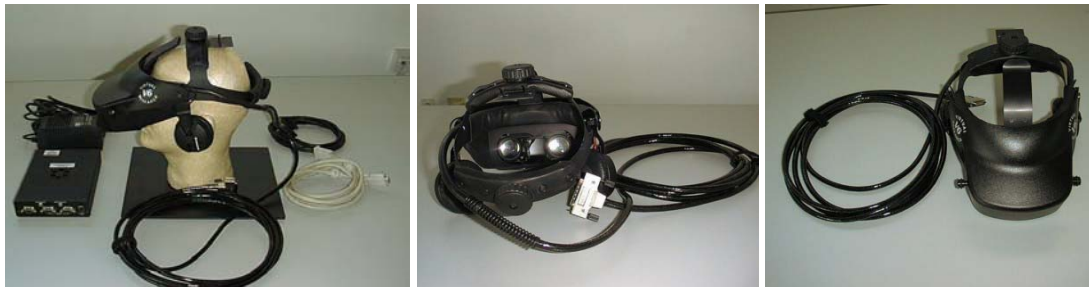
Σχήμα 4.3. Το κράνος Εικονικής Πραγματικότητας V6 της εταιρίας Virtual Research.
