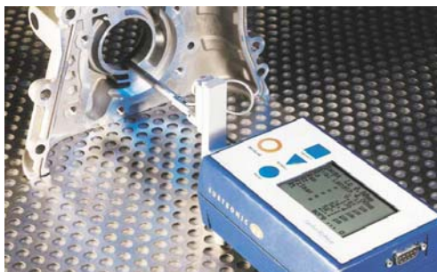
Σχήμα 3.37: Μέτρηση τραχύτητας με επαφή (εικόνα Surtronic).
