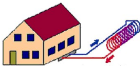
Σχήμα 2.5: Σύστημα κλειστού βρόχου κάθετης ή οριζόντιας σπειροειδούς διάταξης (πηγή: http://geoheat.oit.edu , 2007)
