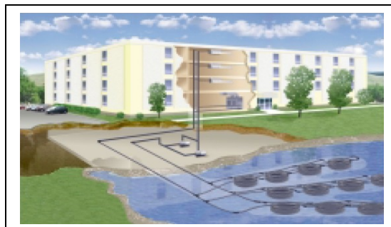
Σχήμα 2.10: Κλειστό σύστημα βρόχου μέσα σε λίμνη (πηγή: www.mcquay.com , 2007)
