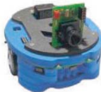
Εικόνα 2.10: Το οπτικό σύστημα EyeCam και το όχημα Hemisson
