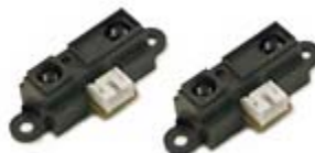
Εικόνα 3.8: Αισθητήρες υπερύθρων, GP2D12
