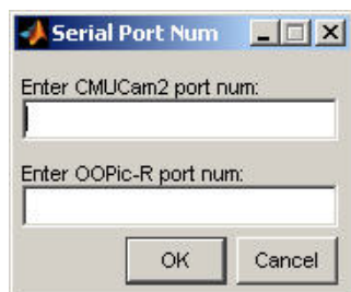
Εικόνα 5.25: Δήλωση αριθμών σειριακής θύρας για κάθε συσκευή
