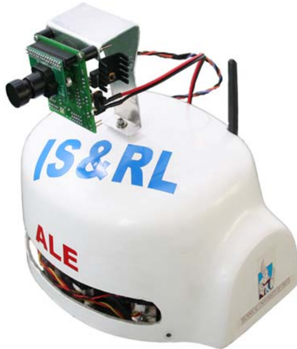
Εικόνα 3.3: Το ρομποτικό όχημα ΑΛΕ ΙΙ, με την προσάρτηση του εικονολήπτη CMUcam2
