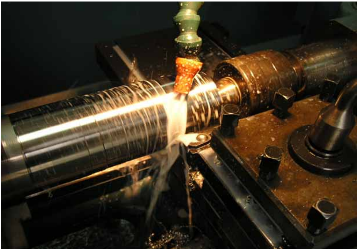
Φωτογραφία 22 : Κοπή με χρήση ψυκτικού και λιπαντικού υγρού.
