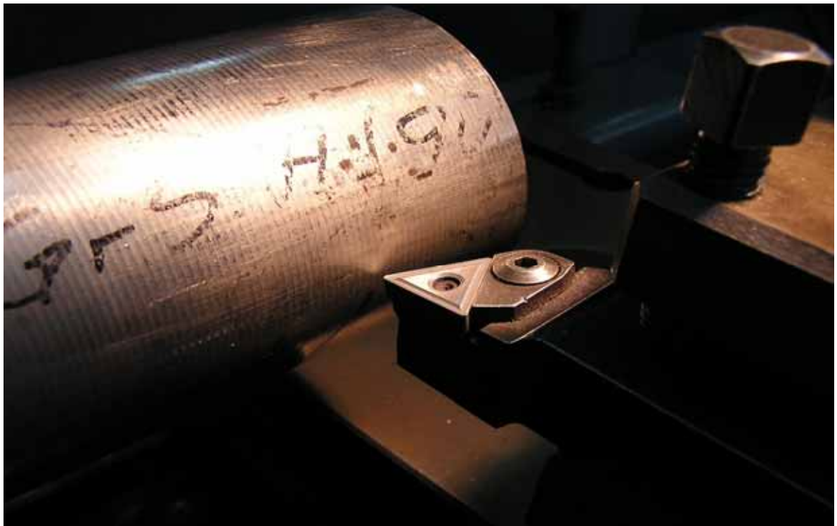
Φωτογραφία 18 : Προετοιμασία κοπής με κοπτικό εργαλείο τόρνου κλίσης 60^\circ .
