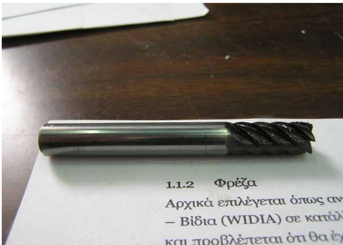
Φωτογραφία 15 : Κοπτικό εργαλείο φρέζας, κονδύλι έξι κοπτικών ακμών (E6MHD1000).
