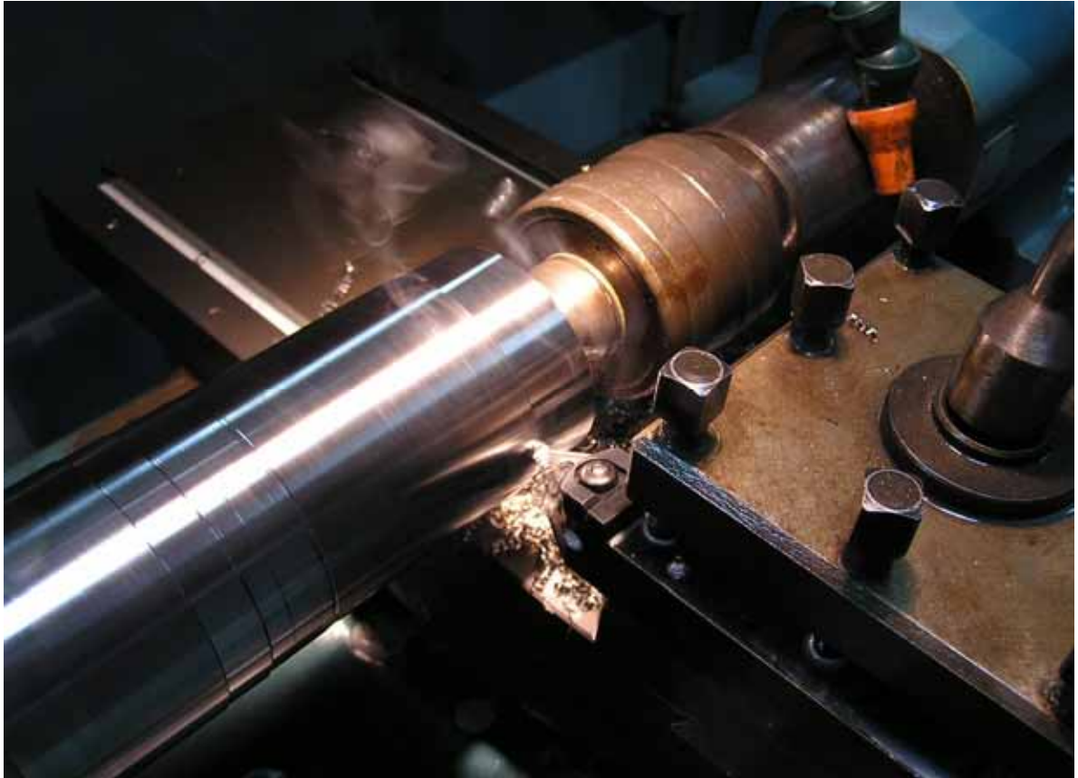
Φωτογραφία 23 : Κοπή χωρίς τη χρήση ψυκτικού και λιπαντικού υγρού.
