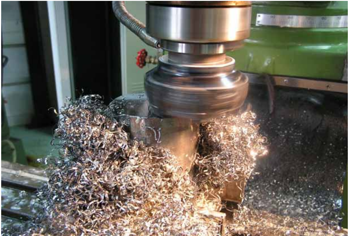
Φωτογραφία 31 : Κοπή μετώπου με μαχαιροφόρα κεφαλή με τη χρήση ψυκτικού και λιπαντικού υγρού.
