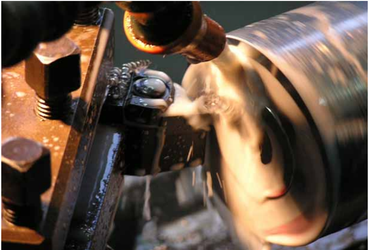
Φωτογραφία 21 : Μετωπική κοπή με χρήση ψυκτικού και λιπαντικού υγρού.
