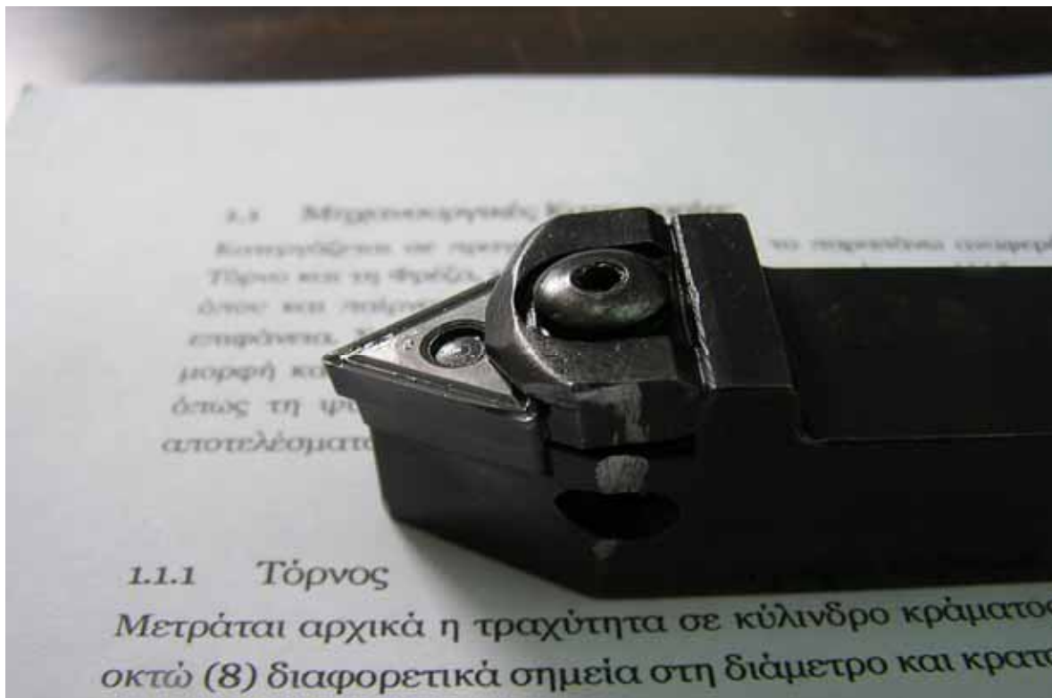
Φωτογραφία 9 : Κοπτικό εργαλείο τόρνου με γωνία κοπής 91^\circ .
