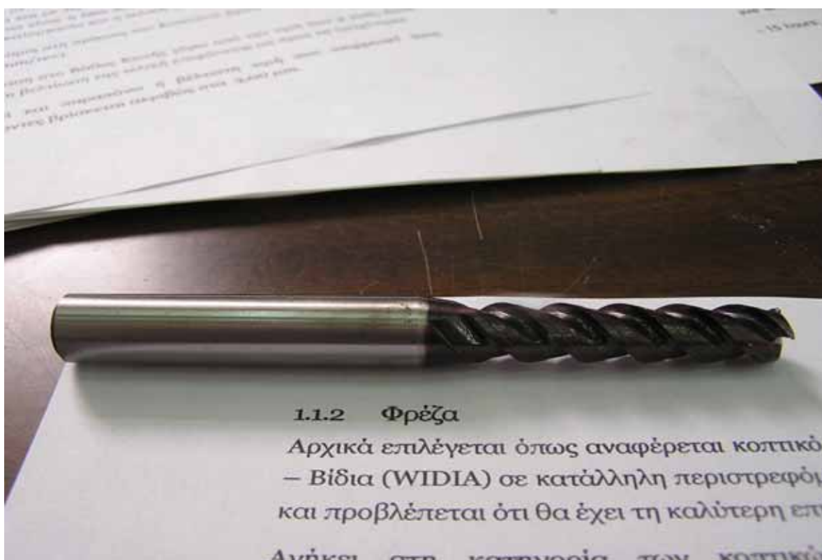
Φωτογραφία 16 : Κοπτικό εργαλείο φρέζας, κονδύλι τριών κοπτικών ακμών (VALHD1000).
