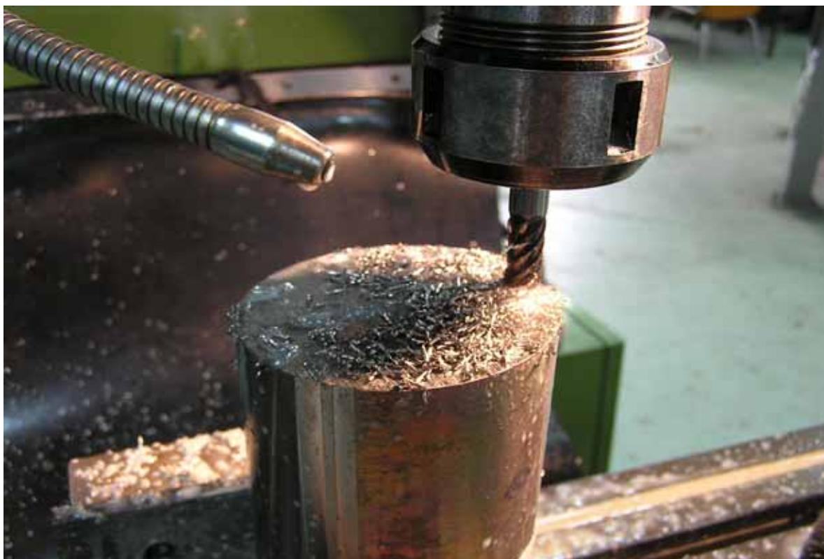
Φωτογραφία 30 : Κοπή μετώπου με κονδύλι χωρίς τη χρήση ψυκτικού και λιπαντικού υγρού.
