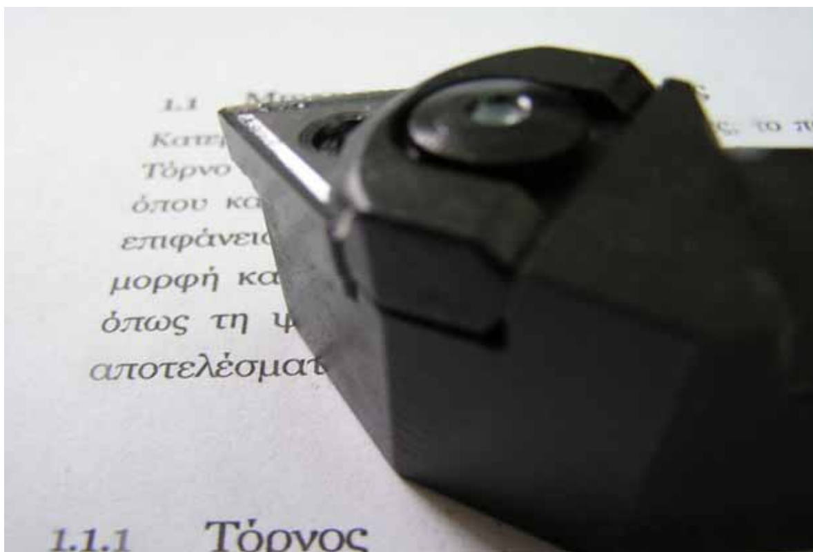
Φωτογραφία 11 : Κοπτικό εργαλείο τóρνου με γωνία κοπής 117^\circ .
