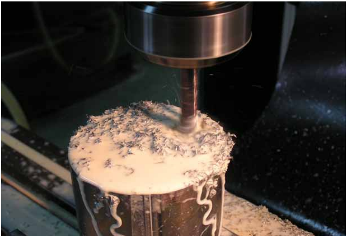
Φωτογραφία 32 : Κοπή μετώπου με κονδύλι με τη χρήση ψυκτικού και λιπαντικού υγρού.
