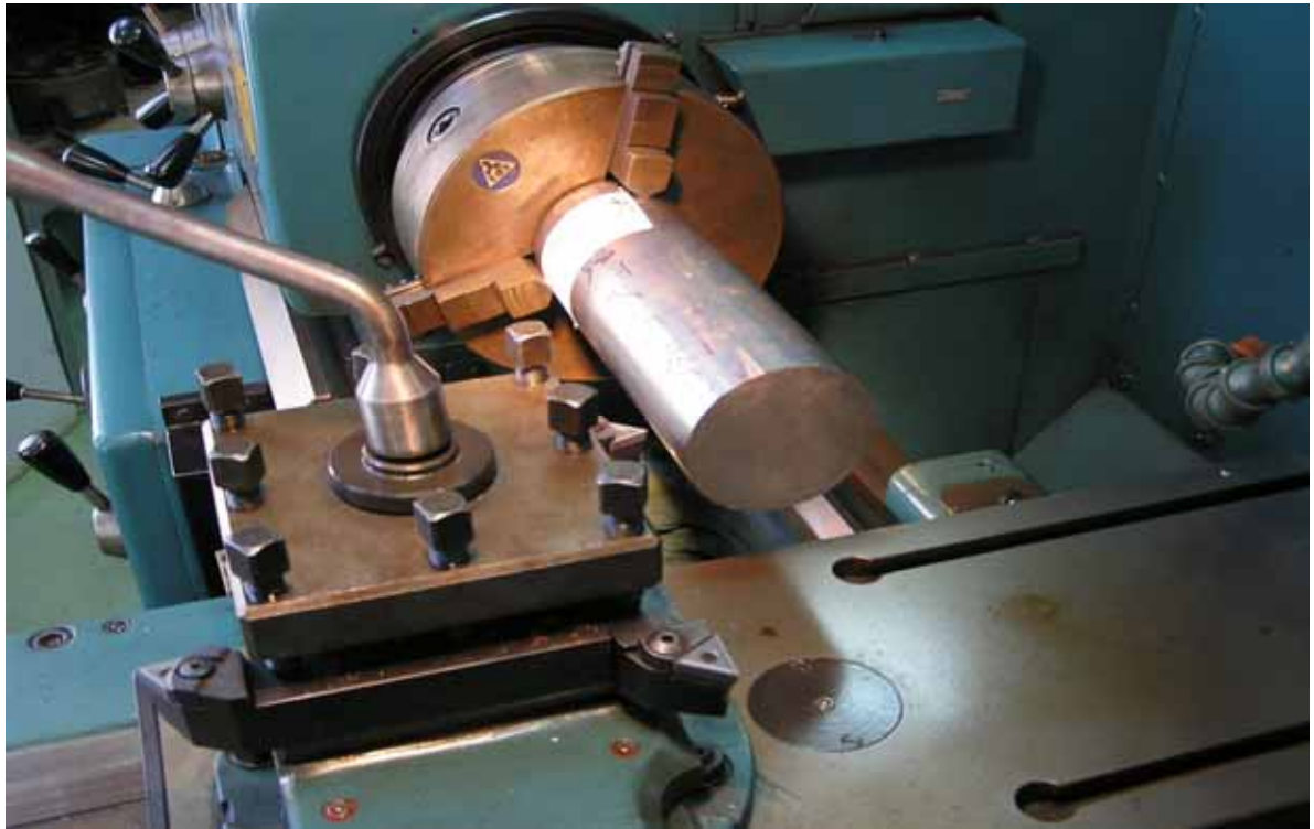
Φωτογραφία 17 : Προετοιμασία κοπής με κοπτικό εργαλείο τόρνου κλίσης 91^\circ .
