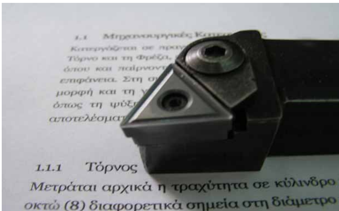
Φωτογραφία 10 : Κοπτικό εργαλείο τόρνου με γωνία κοπής 60^\circ .
