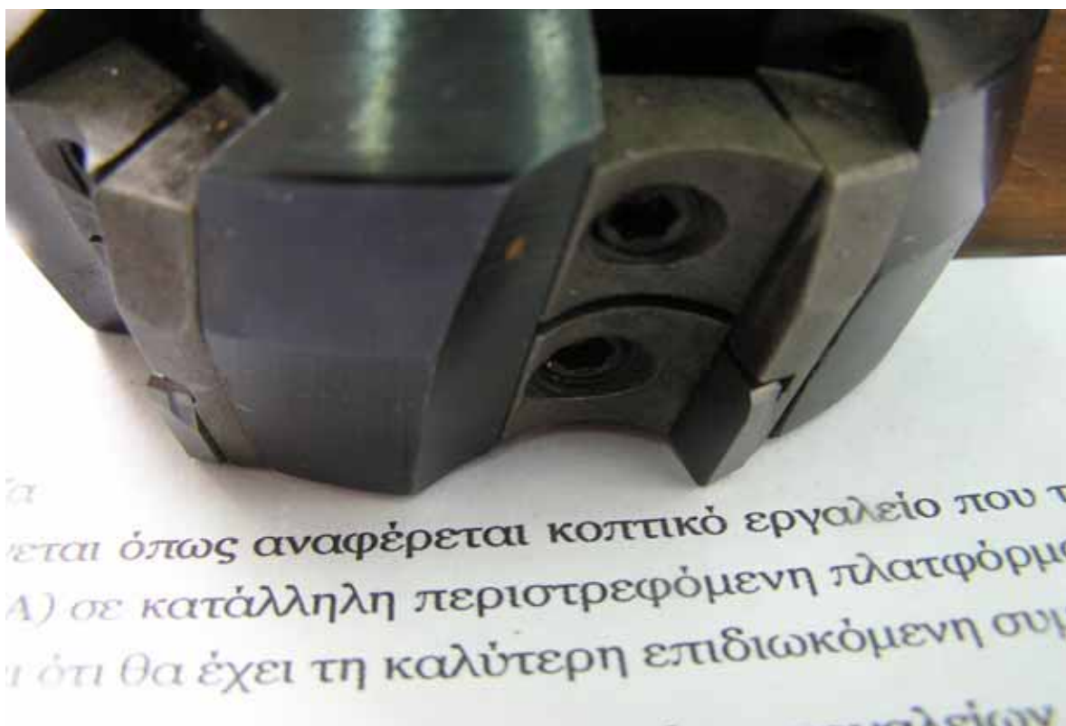
Φωτογραφία 13 : Κοπτικό εργαλείο φρέζας, μαχαιροφόρα κεφαλή με έξι βίδια.
