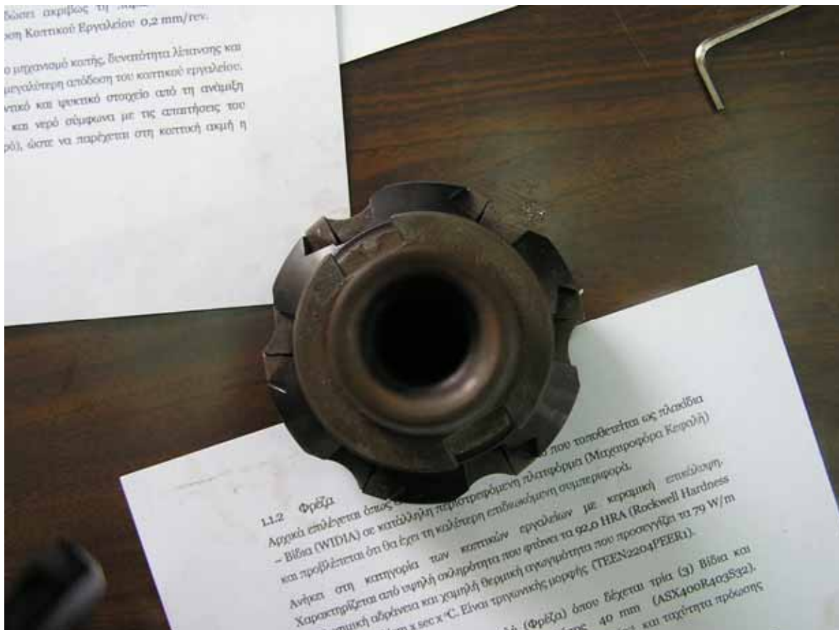
Φωτογραφία 14 : Κοπτικό εργαλείο φρέζας, μαχαιροφόρα κεφαλή με έξι βίδια.
