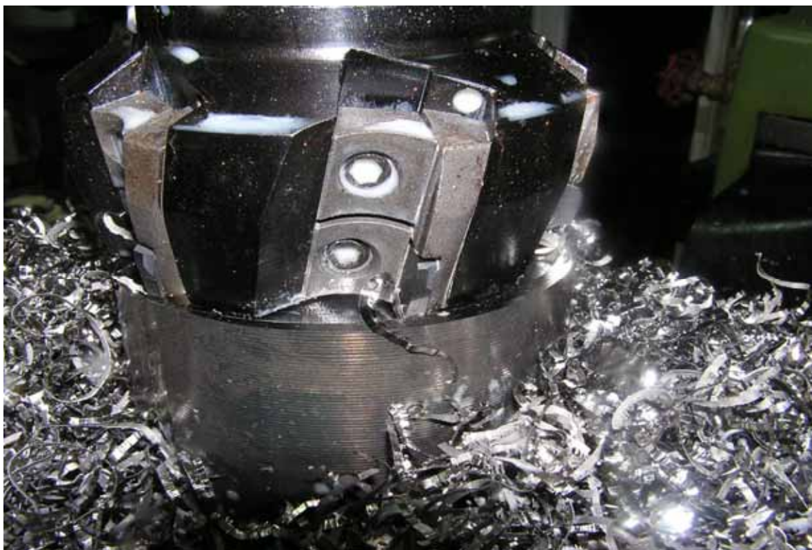
Φωτογραφία 29 : Κοπή μετώπου με μαχαιροφόρα κεφαλή χωρίς τη χρήση ψυκτικού και λιπαντικού υγρού.
