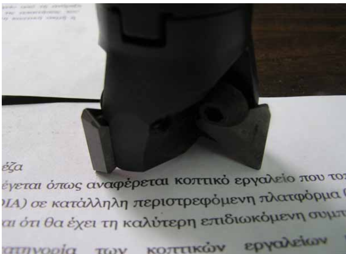
Φωτογραφία 12 : Κοπτικό εργαλείο φρέζας, μαχαιροφόρα κεφαλή με τρία βίδια.
