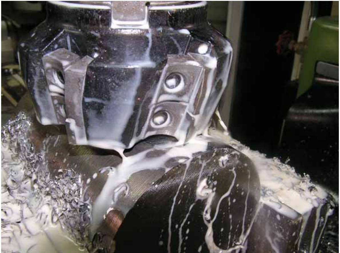
Φωτογραφία 33 : Διαμήκης κοπή με μαχαιροφόρα κεφαλή.
