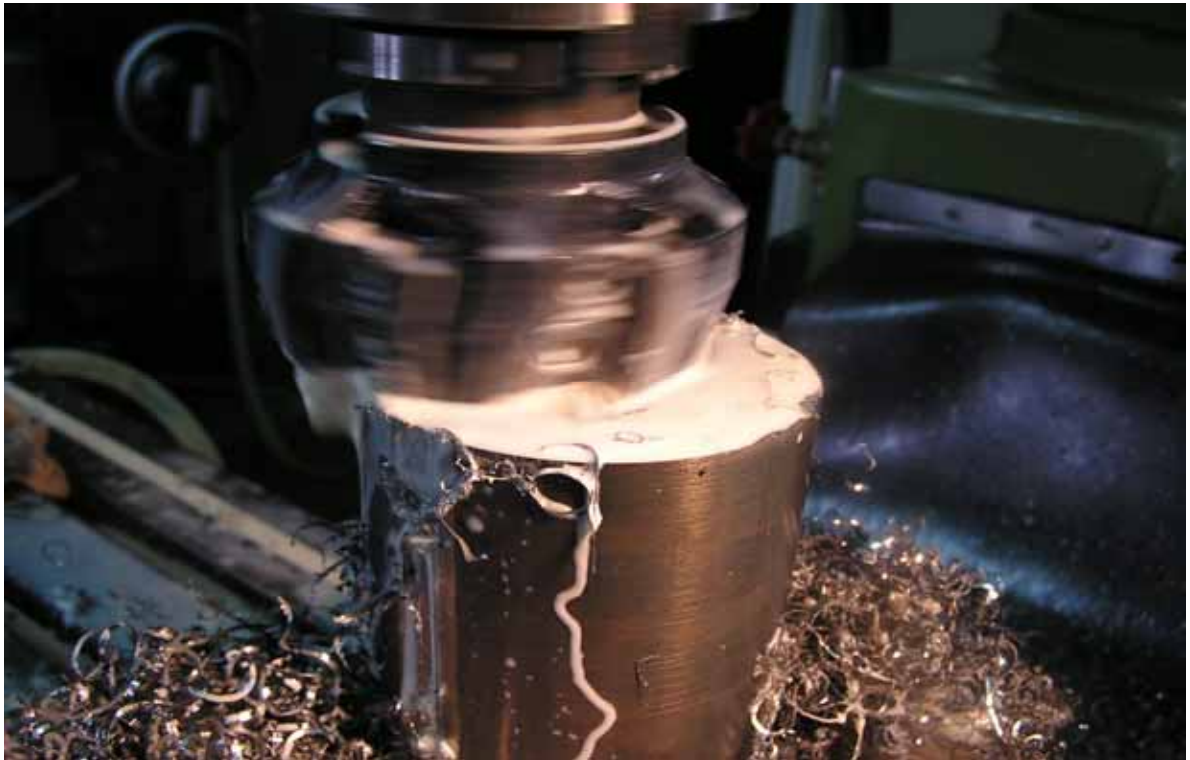
Φωτογραφία 27 : Προετοιμασία κοπής με μαχαιροφόρα κεφαλή.
