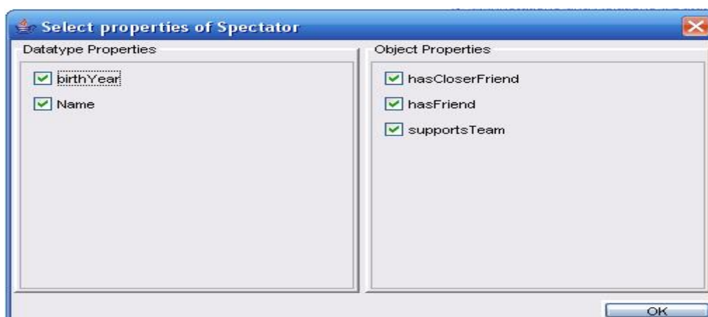
Εικόνα 73: Η όψη του παραθύρου επιλογής ιδιοτήτων για τύπο που δεν είχε επιλεγεί ύστερα από τα δύο βήματα του οδηγού.
