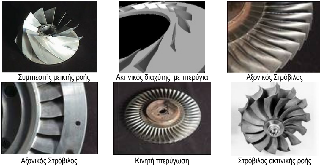
Εικόνα 1.32. Παραγόμενες γεωμετρίες του TURBODesign 1 [23].
