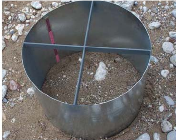
Σχήμα 4.7. Διηθητόμετρο που χρησιμοποιήθηκε στα πειράματα προσδιορισμού της διηθητικής ικανότητας του ιζήματος.
