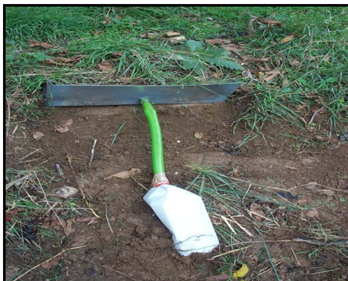
Σχήμα 4.4. Λυσίμετρο που εγκαταστάθηκε σε μόνιμες καλλιέργειες (πορτοκαλιές).
