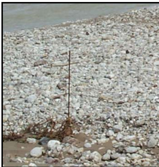
Σχήμα 4.5. Σιδερένιοι ράβδοι παρακολούθησης της οξείδωσης στο τμήμα μελέτης του Κράθι ποταμού
