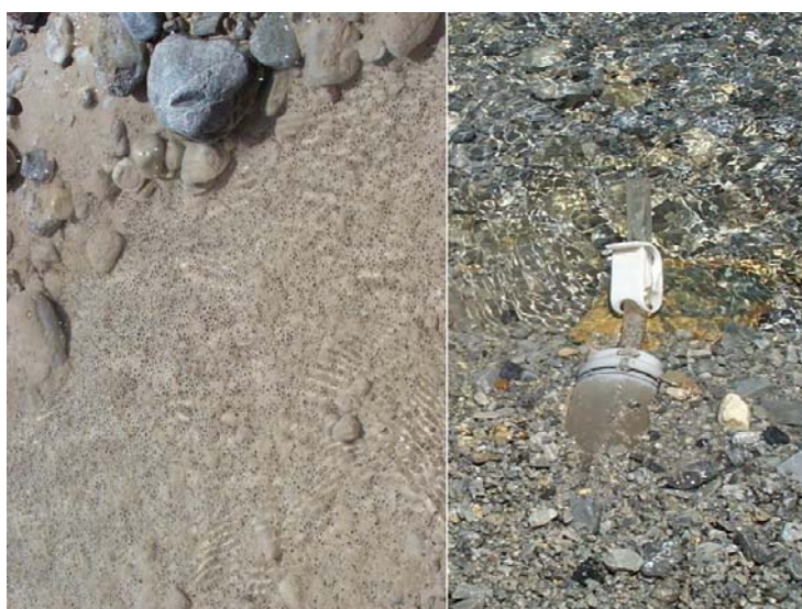
Σχήμα 6.14. Πειράματα προσδιορισμού αναπνοής των ιζημάτων in situ .
