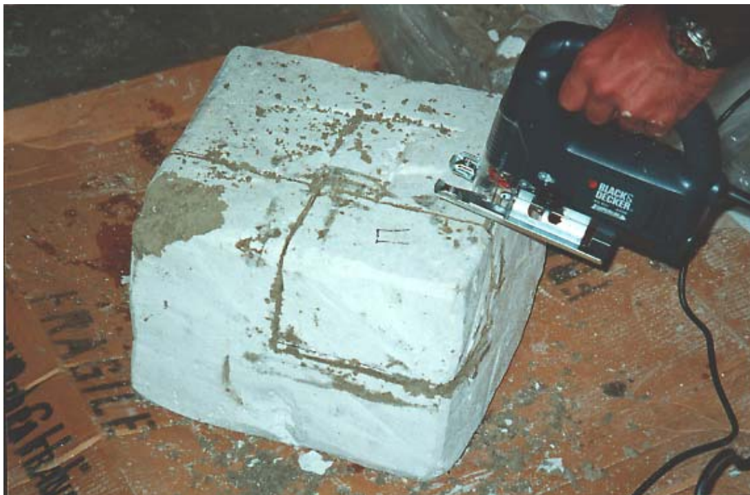
Φωτ. 7-3 Κοπή τμήματος του αδιατάρακτου τεμάχους για τη διαμόρφωση δοκιμίου
