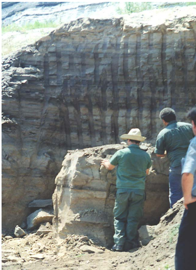
Φωτ. 7-2 Εκσκαφή και διαμόρφωση αδιατάρακτου δείγματος
