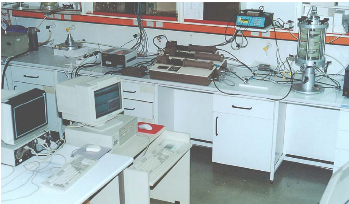
Φωτ. 10-1 Σύστημα τριαξονικής φόρτισης για τη διερεύνηση της δυστροπίας των μαργών
