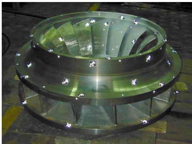
Σχήμα 1.7 – Πτερωτή με προσδεμένα τα πτερύγια στην κεφαλή τους.
