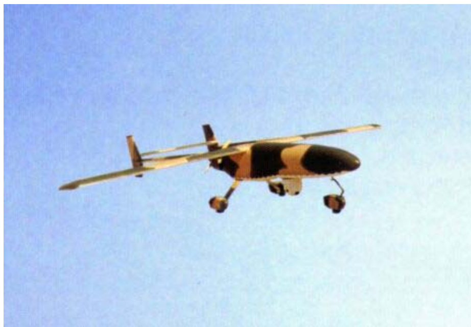
Εικόνα 4.1: Μη επανδρωμένο αεροσκάφος (UAV) με προσαρμοσμένη κάμερα.
