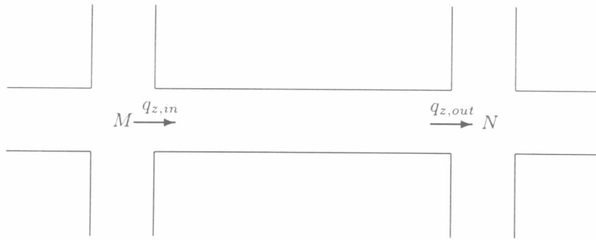
Σχήμα 2.5: Απλοποιημένη απεικόνιση συνδέσμου αστικού δικτύου. Ο σύνδεσμος δέχεται την εισροή q_{z,in} από τον κόμβο M και έχει εκροή q_{z,out} στον κόμβο N .
