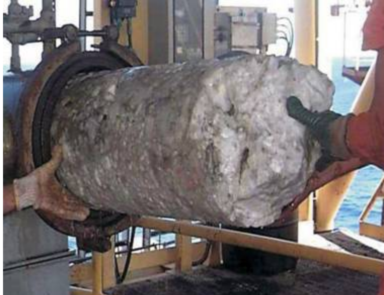
Εικόνα 1.6: Υδρίτης που σχηματίστηκε σε υποθαλάσσιο αγωγό μεταφοράς φυσικού αερίου της εταιρείας Petrobras, (Mao et al., 2007).
