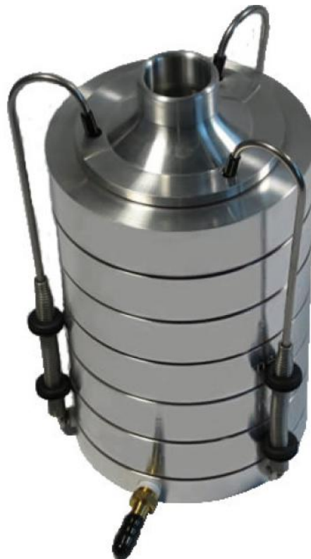
Σχήμα 18: Δειγματολήπτης βιοαεροζόλ Andersen 6 σταδίων.
