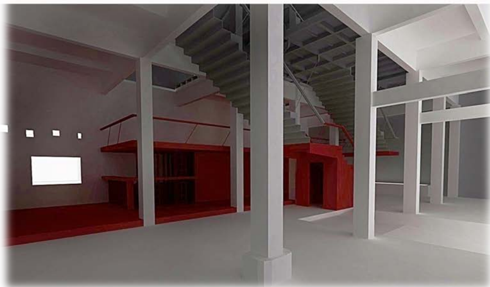
Σχέδιο24: Απεικόνιση δομικού συστήματος (Ημιόροφος από οπλισμένο σκυρόδεμα με κόκκινο)
