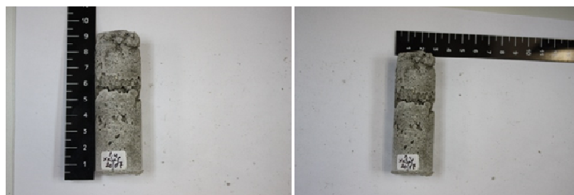
Εικόνα 5.3 Τα δοκίμια ιπτάμενης τέφρας ΛΠΤΟΛ με χαλαζιακή άμμο πριν την δοκιμή αντοχής σε θλίψη
