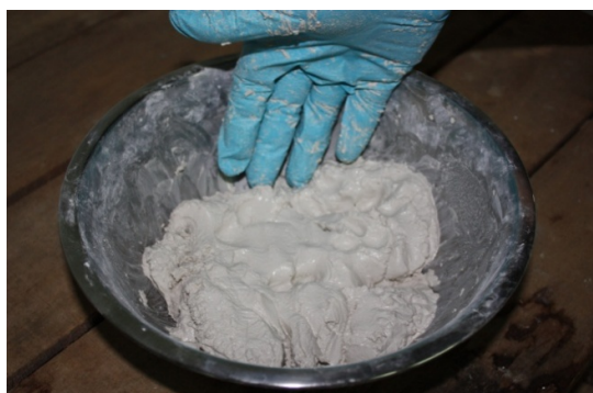
Εικόνα 4.5 Μίγμα Μετακαολίνη, Ασβέστη, νταμαρίσιας άμμου και νερού
