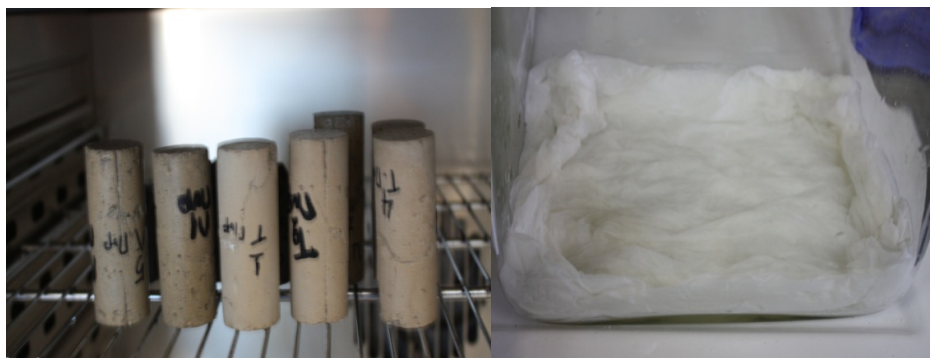
Εικόνα 3.2 α) Τα δοκίμια τοποθετημένα στον φούρνο για απομάκρυνση της υγρασίας και β) Τα ειδικά διαμορφωμένα δοχεία με τα τοποθετημένα στρώματα απορροφητικού χαρτιού
