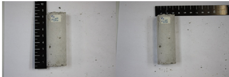
Εικόνα 5.6 Τα δοκίμια τσιμέντου με πυριτική άμμο πριν την δοκιμή αντοχής σε θλίψη
