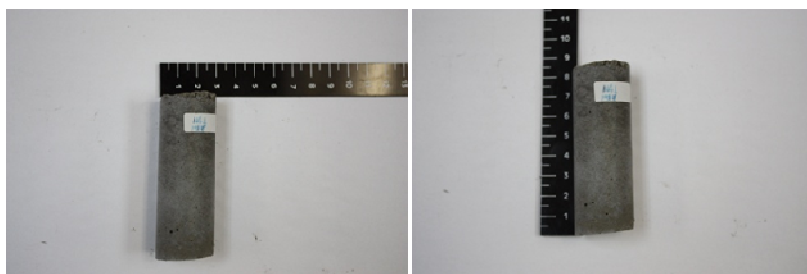
Εικόνα 5.4 Τα δοκίμια ιπτάμενης τέφρας Μ.Α. με πυριτική άμμο πριν την δοκιμή αντοχής σε θλίψη
