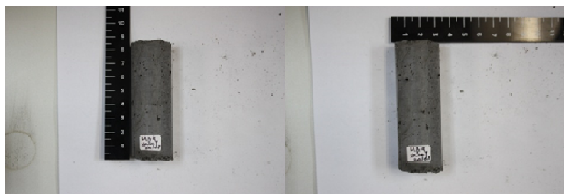
Εικόνα 5.5 Τα δοκίμια ιπτάμενης τέφρας Μ.Α. με χαλαζιακή άμμο πριν την δοκιμή αντοχής σε θλίψη
