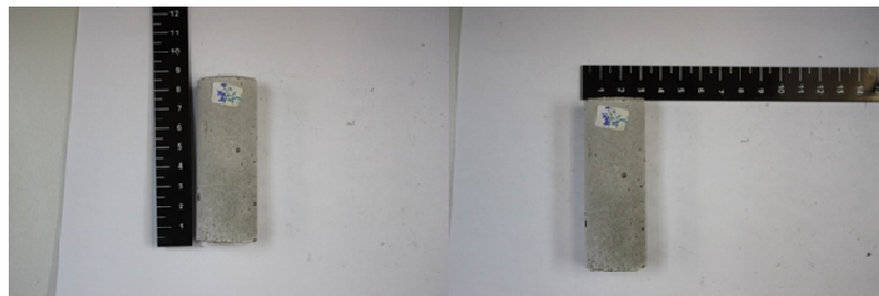
Εικόνα 5.7 Τα δοκίμια τσιμέντου τέφρας με χαλαζιακή άμμο πριν την δοκιμή αντοχής σε θλίψη
