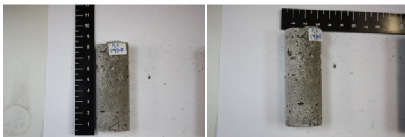
Εικόνα 5.2 Τα δοκίμια ιπτάμενης τέφρας ΛΠΠΤΟΛ με πυριτική άμμο πριν την δοκιμή αντοχής σε θλίψη
