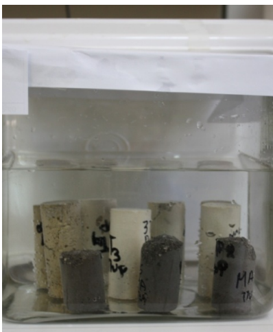
Εικόνα 3.4 Το φαινόμενο της υδατοαπορροφητικότητας με βύθιση των δοκιμίων σε νερό
