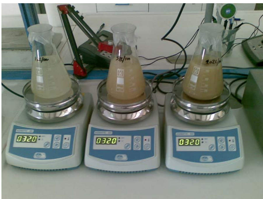
Σχήμα 4.2 : Εργαστηριακή διάταξη δοκιμών εκχύλισης σε κωνικές φιάλες υπό ανάδευση
