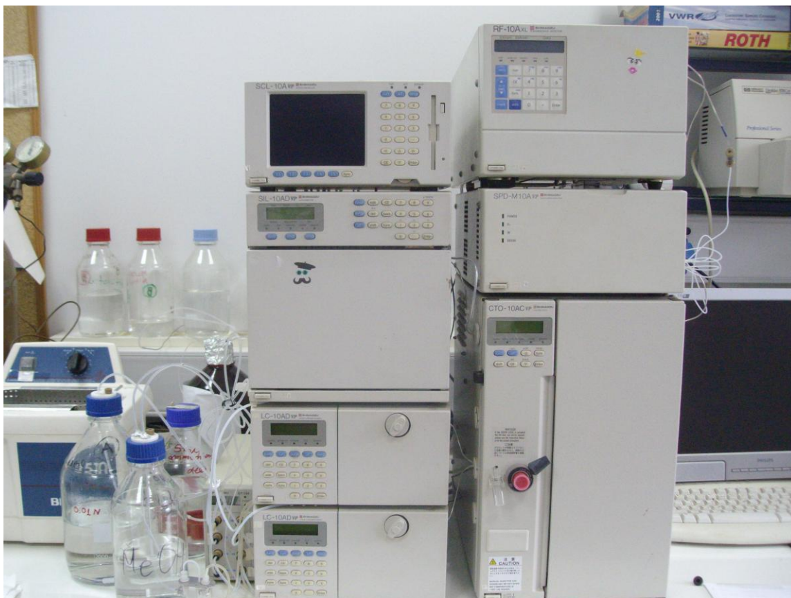
Εικόνα 3.3: Διάταξη Υγρής Χρωματογραφίας Υψηλής Πίεσης (HPLC, Shimadzu®).
