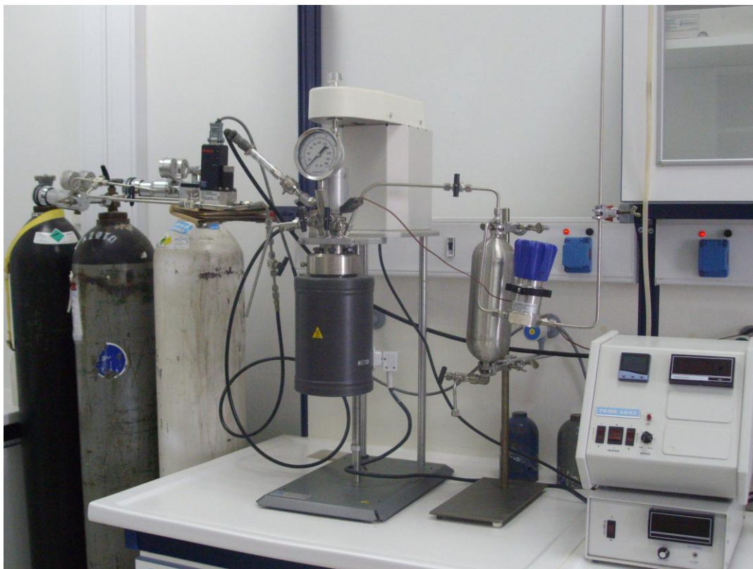
Εικόνα 3.1: Πειραματική διάταξη της υγρής οξείδωσης
