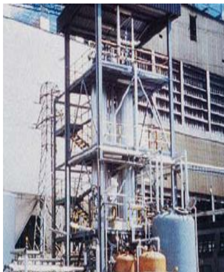
Εικόνα 2.1: (α) Διάγραμμα ροής μίας μονάδας LoProx, (β) LoProx σε Φαρμακευτική μονάδα, Anlage, La Flgura, Ισπανία, δυναμικότητας 8m 3 /h, 1993(LOPROX-Low Pressure Wet Oxidation for the Treatment of Wastewater and Sludge)
