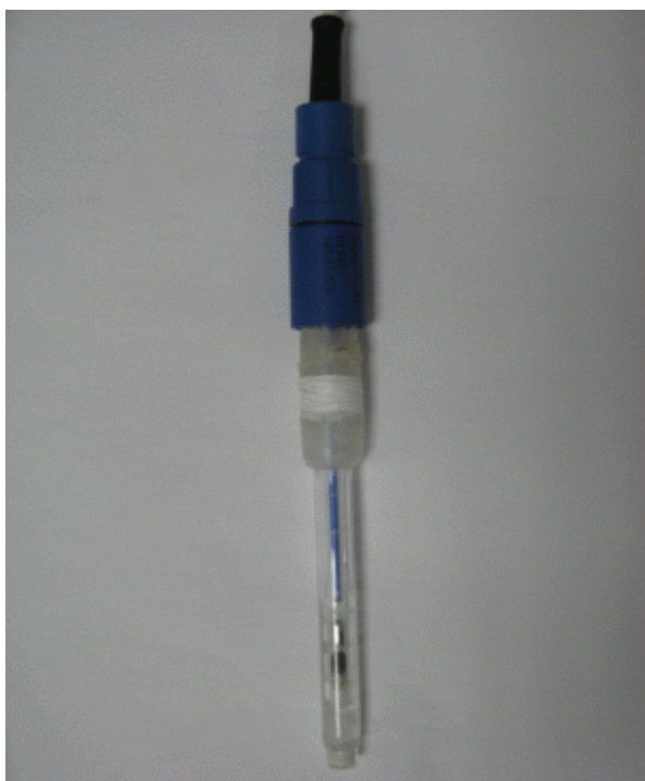
Εικόνα 2.8: Ηλεκτρόδιο αναφοράς (RE) υδραργύρου ( \text{Hg}/\text{Hg}_2\text{SO}_4/\text{K}_2\text{SO}_4\text{sat} ).
