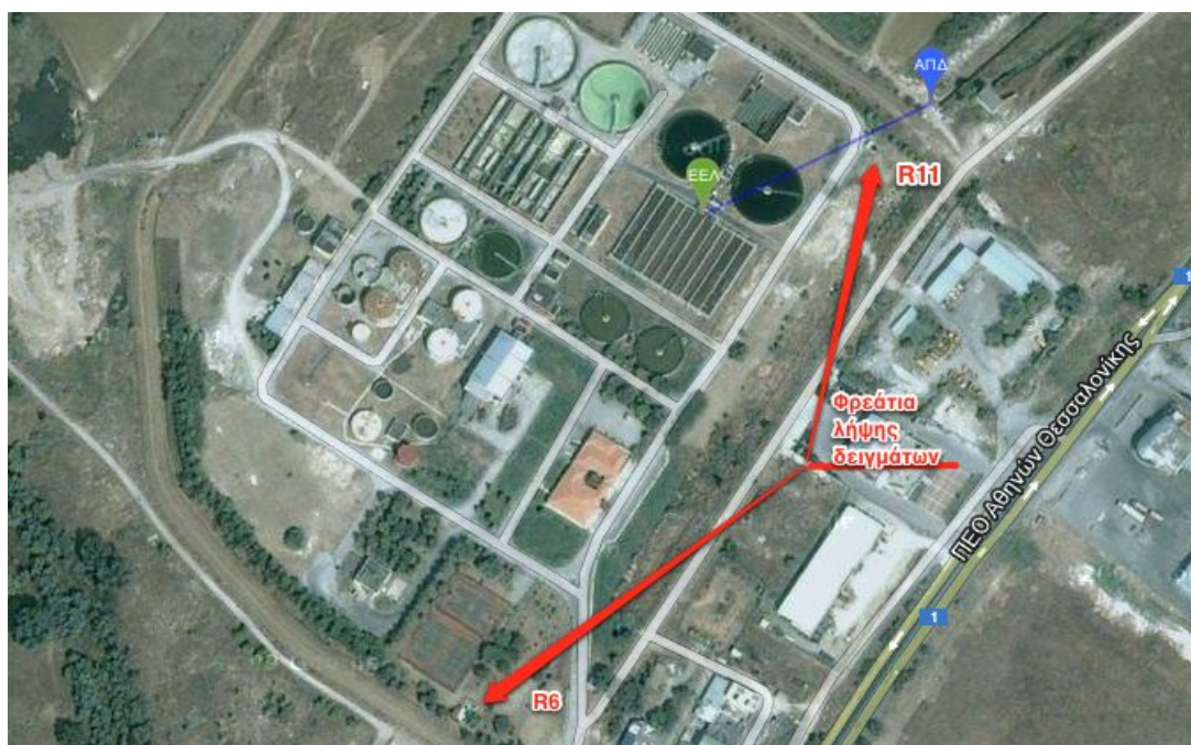
Εικόνα 15: Φρεάτια δειγματοληψίας R6 (εισόδου) και R11 (εξόδου)
