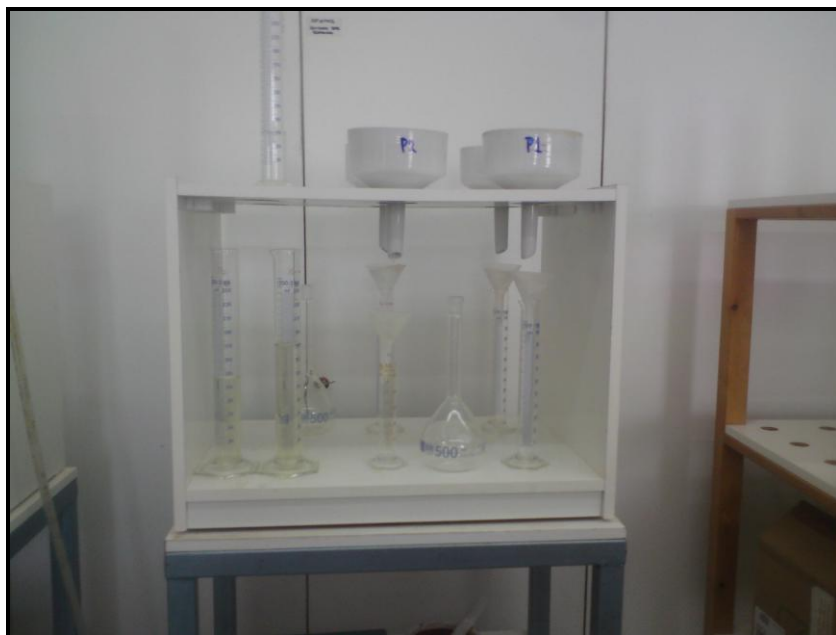
Σχήμα 4.18: Χωνιά Buchner και ογκομετρικοί κύλινδροι με πλαστικά χωνάκια και φίλτρα για τη συλλογή του εκχυλισμάτων
