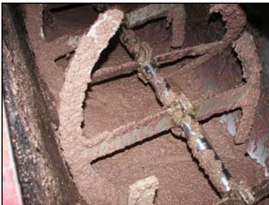
Σχήμα 2.6: Μάλαξη ελαιοζύμης
