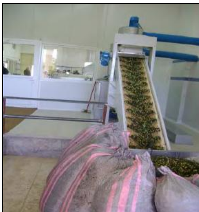
Σχήμα 2.2: Χοάνη παραλαβής και ταινία μεταφοράς του ελαιοκάρπου
