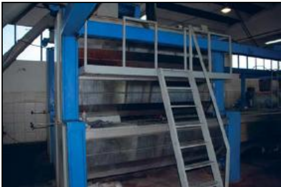
Σχήμα 2.5: Σπαστήρας για τη θραύση του ελαιοκάρπου
