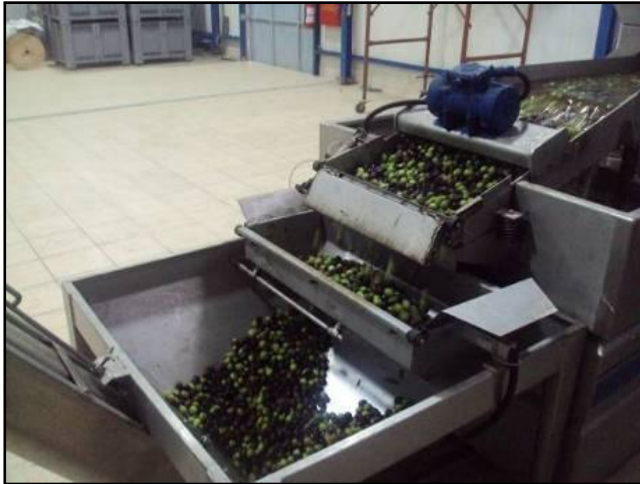
Σχήμα 2.4: Πλύσιμο ελαιοκάρπου
