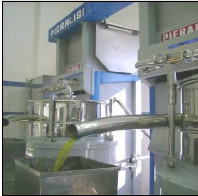
Σχήμα 2.8: Σύστημα κατακόρυφων φυγοκεντρικών διαχωριστήρων για τον καθαρισμό του ελαιόλαδου
